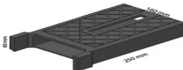
Figure I.8 : Schéma d'un ouvrage en gargouille
