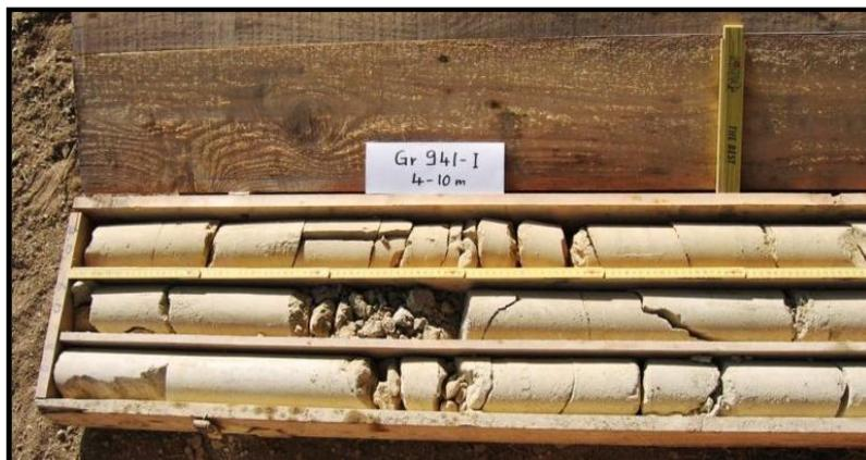
**Fig. Annexe. 11 :** Caisse de carottes prélevées après un sondage.
