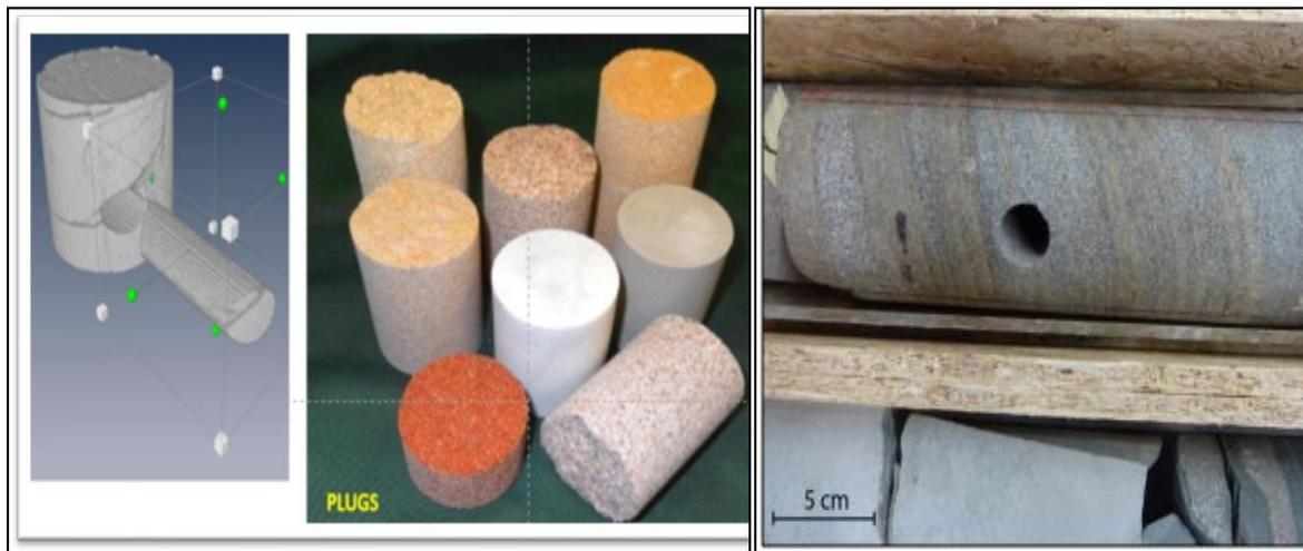
**Fig. Annexe. 12 :** Présentation d'une carotte avec prélèvement d'un Plug.
