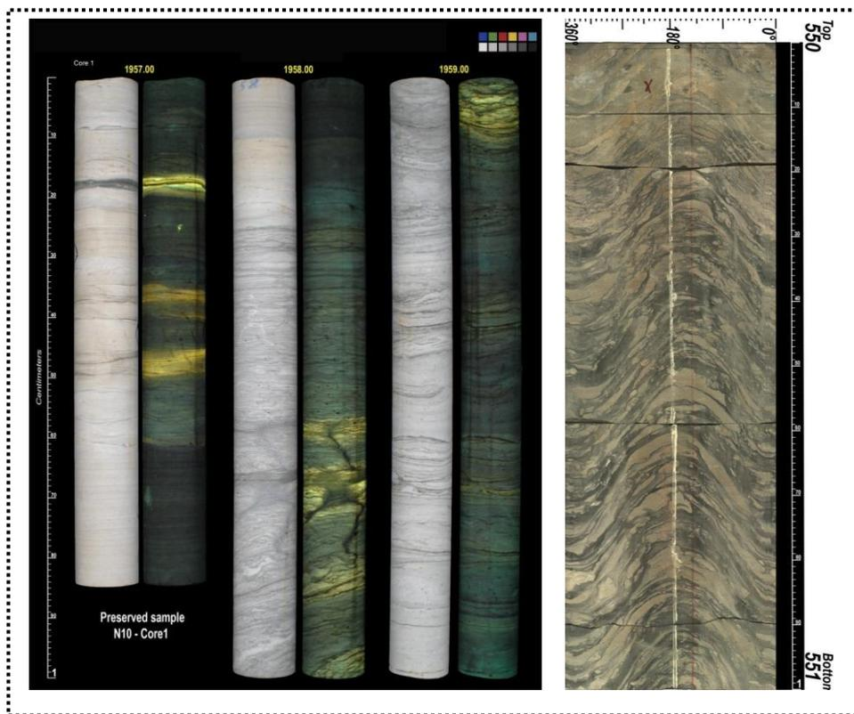
**Fig. Annexe. 13 :** Exemple de photographie sous Lumière Blanche/Ultraviolet et de photographie 360° Vue plane.
