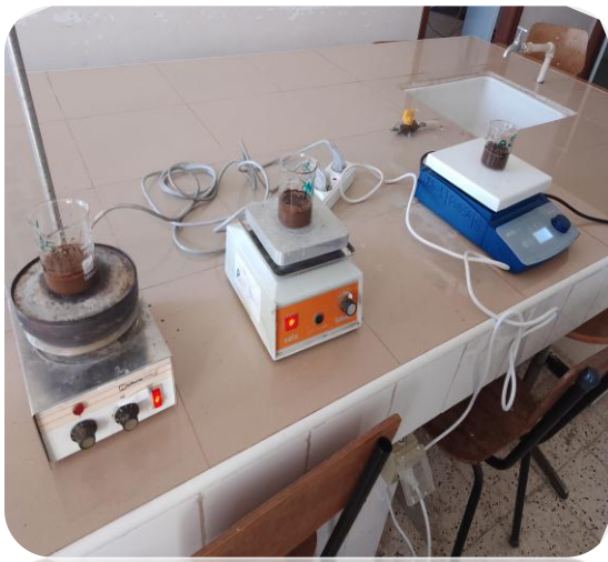
Figure9. Illustration de la mesure du pH de la solution du sol: (a) rapport de suspension et (b) la lecture à l'aide d'un ph -mètre
