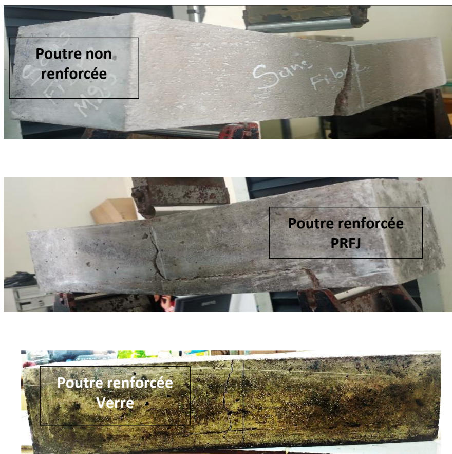
Figure III.12 : Modes de rupture des poutres renforcées avec le verre et le jute et de la poutre témoin
