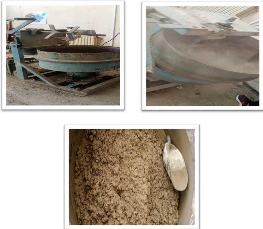
Figure II.9 : Fabrication du béton dans un malaxeur à axe vertical
