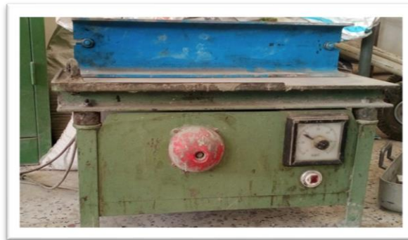
Figure II.11 : Vibration du béton.
