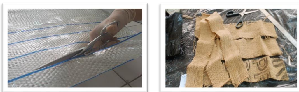
Figure II.6 : Préparation des tissus de fibre de jute et de verre
