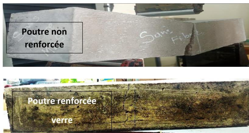
Figure. III.3 : Modes de rupture de la poutre renforcée avec le tissu de verre et la poutre non renforcée.
