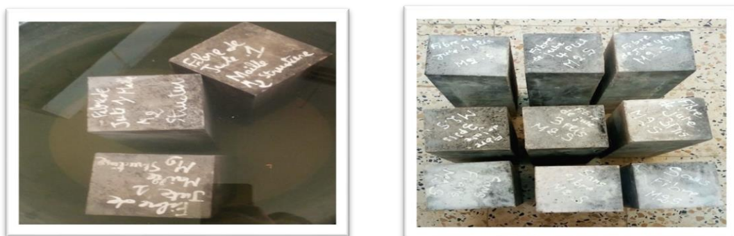
Figure II.12 : a) Epreuves référencées b) Cure d'hydratation du béton.
