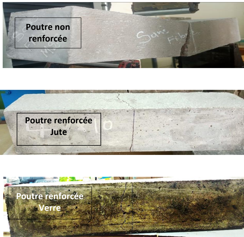
Figure. III.6 : Modes de rupture des poutres renforcées avec le verre et le jute et de la poutre témoin
