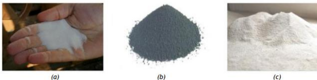
Figure I.10 : Exemple de charges utilisées dans les matériaux composites organiques [4]
