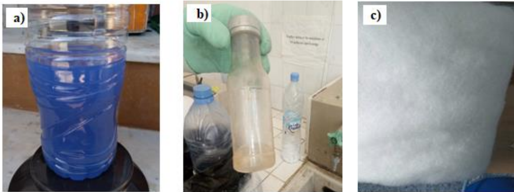
Figure III.1 : Les matériaux utilisés pour l'élaboration du matériau composite a) La résine polyester, b) Le durcisseur et c) La charge, la ouate.
