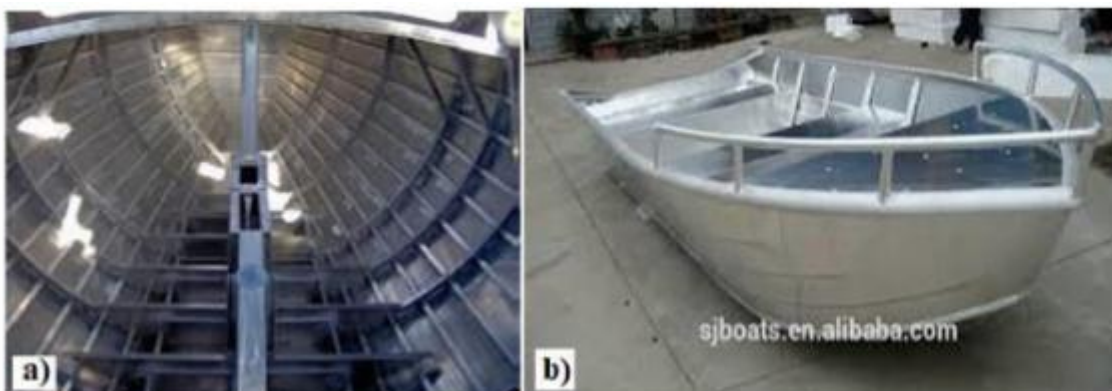
a) Charpente en aluminium
