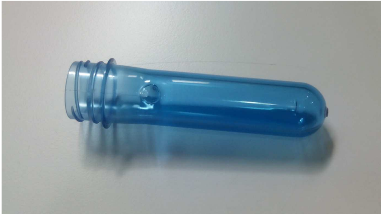
Fig.IV.4 Déformation causée par l'extraction des préformes
