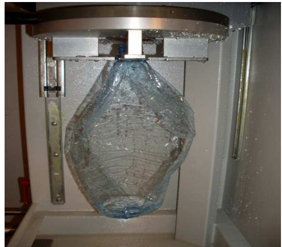
Fig. III.1 Test éclatement (usine Lalla khadidja)
