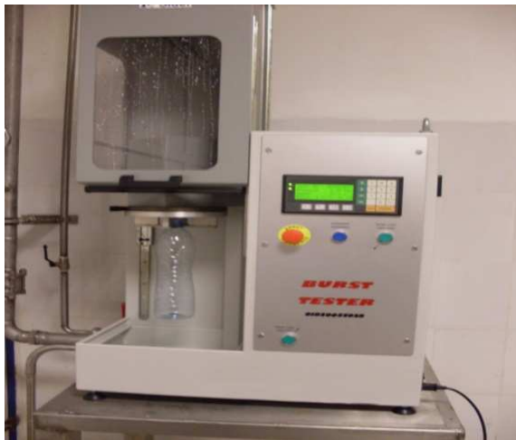
Fig. III.1 Test éclatement (usine Lalla khadidja)
