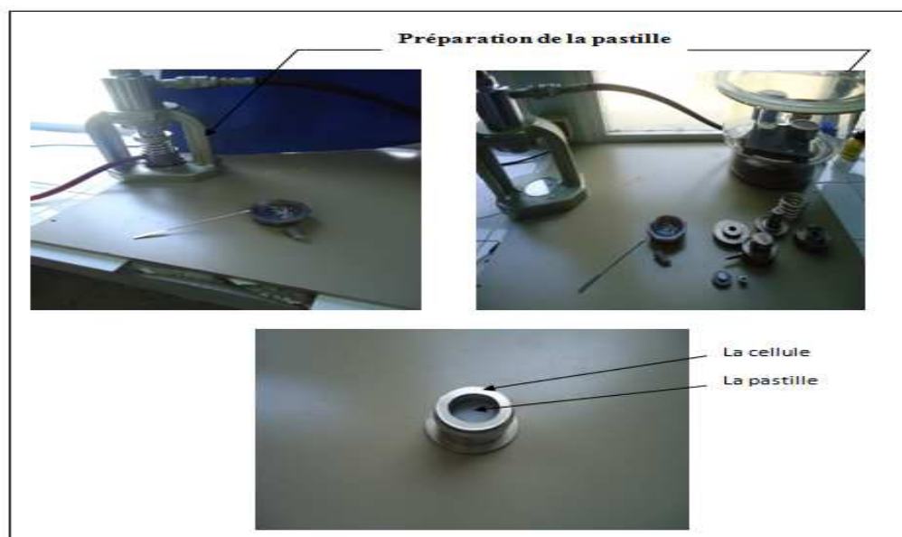
Fig. III.9 Différentes étapes de préparation de la pastille.
