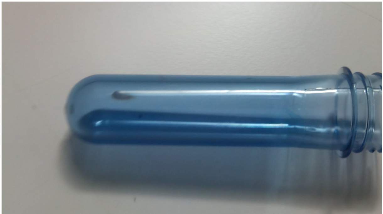
Fig.IV.3 Présence de Corps étranger ou matière dégradée
