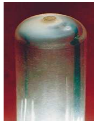
crystallisation du point d'injection
