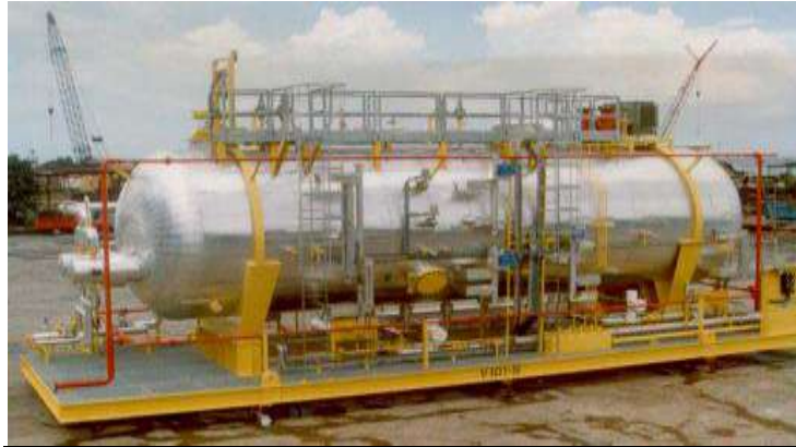
Figure II-9 : Vue extérieure d'un dessaleur électrostatique.
