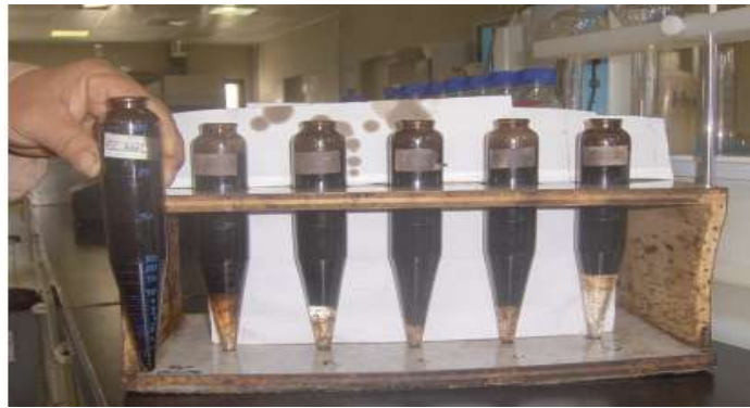
Figure IV-7 : Eau décantée après 90 min à la dose 40 ppm ; 30°C.
