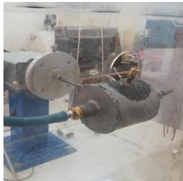
Figure(III.4) : chambre de tranquillisation reliée par une tige à la balance aérodynamique accompagnée d'un manomètre et d'une tuyère convergente.
