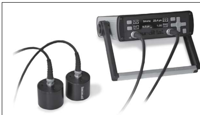
Figure I.22. Appareil d'auscultation sonique punditLab [25]
