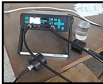
Figure II.5. : Appareil de test ultrasonique Pundit-Lab
