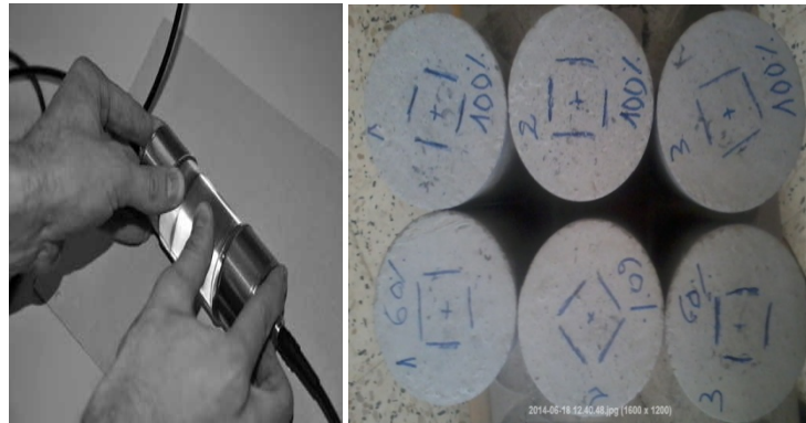
Figure II.6.: calibrage de l'appareil, marquage des points d'essai
