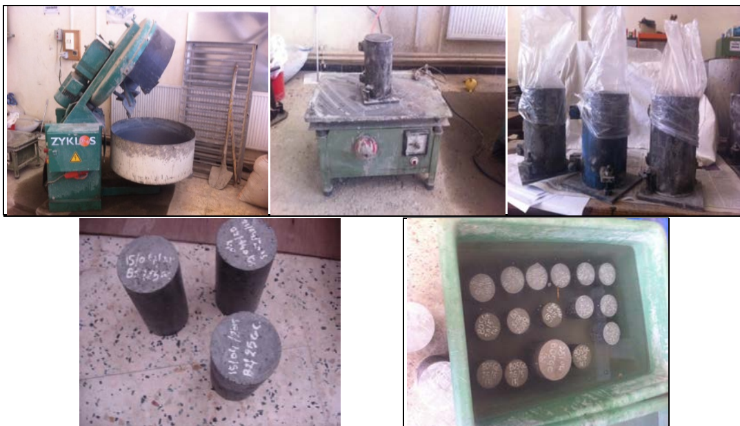
Figure II.4. Préparation des éprouvettes et conditions de conservation.
