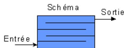
Figure VI.7 : schéma représentatif des chicanes
