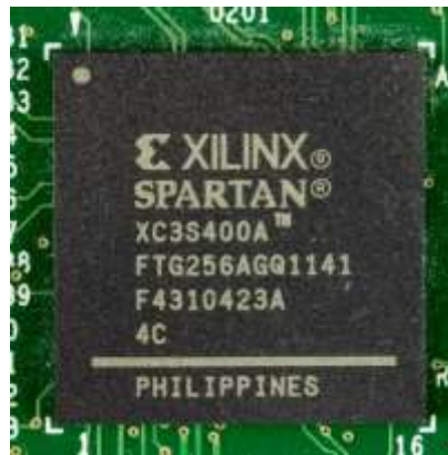
Figure (I.10) : FPGA de Xilinx (modèle Spartan XC3S400) avec 400 000 portes.
