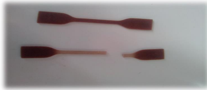
Figure II-29 : Eprouvettes avant et après test d'attraction (original 2017).
