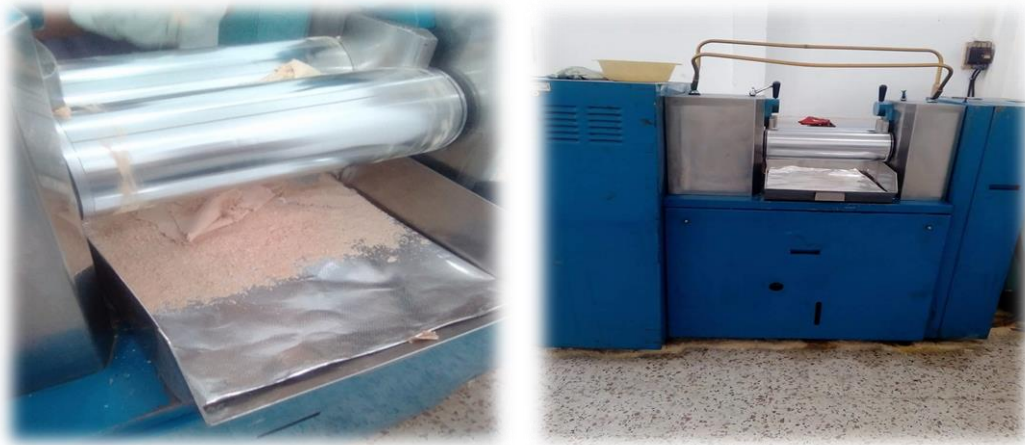
Figure II-23 : Mélangeur à deux cylindres de marque LESCUYER (original 2017).
