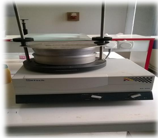
Figure II-20 : Tamis utilisé de marque RETSCH AS 200 (original 2017).
