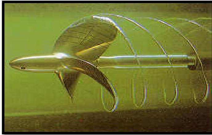
**Figure VIII-12): La cavitation est une formation des bulles de vapeur due à une baisse de pression**
