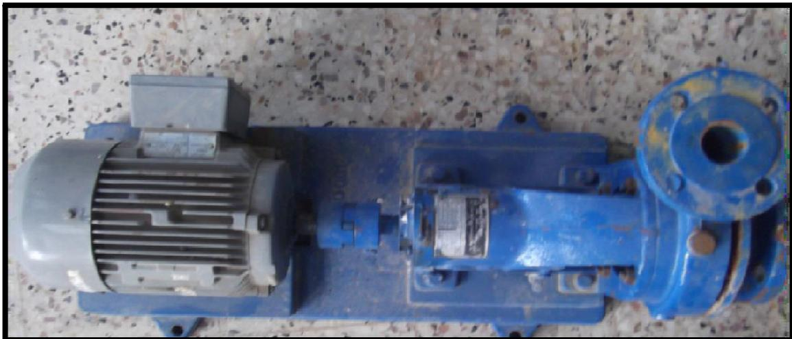
**Figure VIII-2) : Pompe monocellulaire à axe horizontal.**
