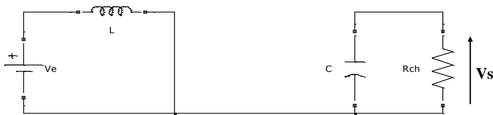
Figure II.11. Schéma équivalent de convertisseur boost K
