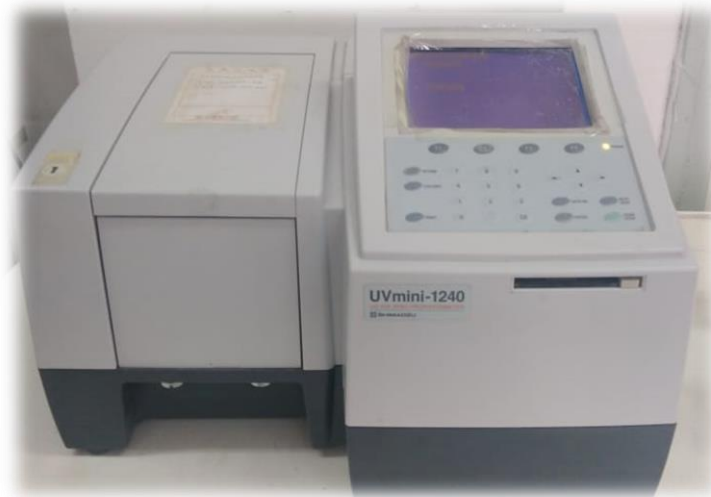
Figure 38 : spectrophotomètre UV pour mesurer l'absorbance
