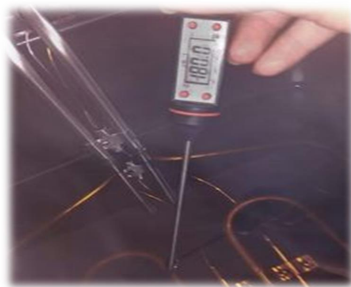
Figure 24 : contrôle de la température de chauffage
