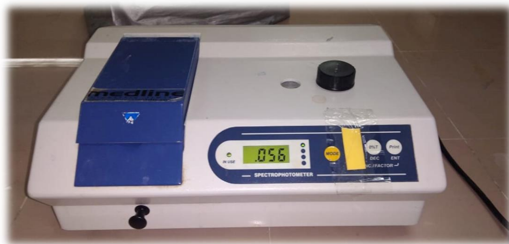
Figure 37 : spectrophotomètre pour la détermination de la teneur en composés phénoliques
