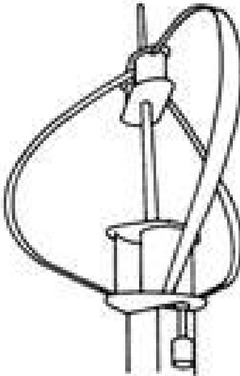
**Figure II.22 : Eolienne de DARRIEUS**
