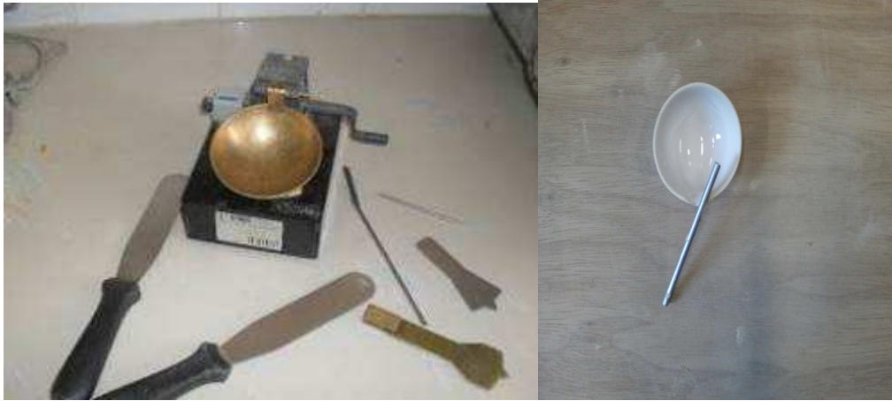
Figure[VI.9] : Appareil de Casagrande et outil à rainurer
