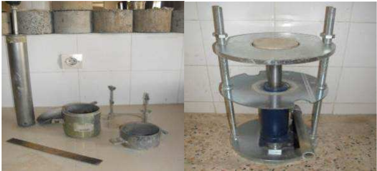
Figure [VII.7] : Matériel de l'essai de compactage.
