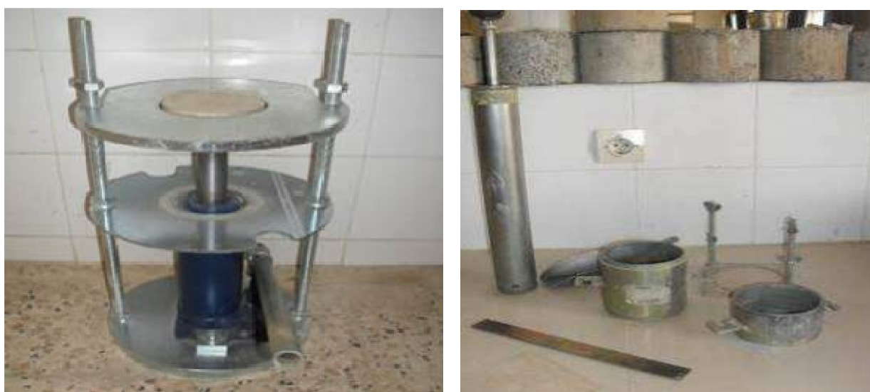
Figure [VI.5] : Matériel de l'essai de compactage.
