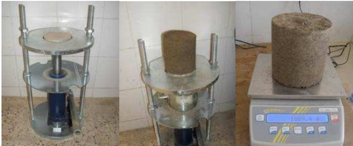
Figure [VI.7] : Etape de démoulage du moule Proctor.
