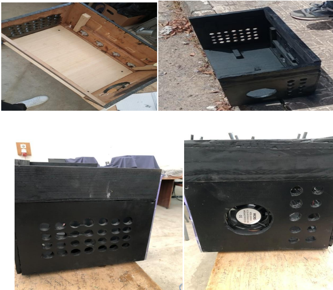
Figure III.2.2.3 : renforcement et finition du boîtier électrique
