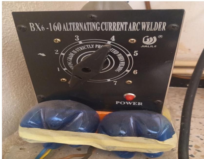
Figure II.4.2 : poste à souder (transformateur)
