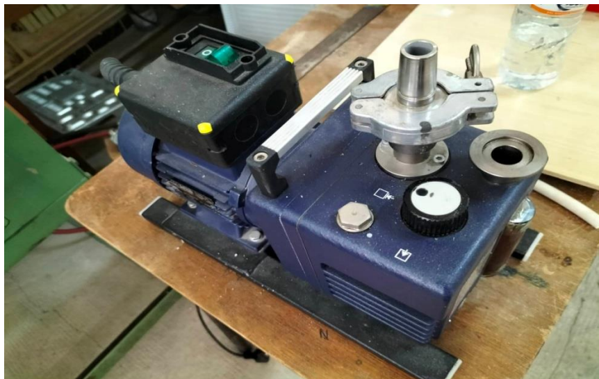
Figure III.2.1.1.c : pompe à vide
