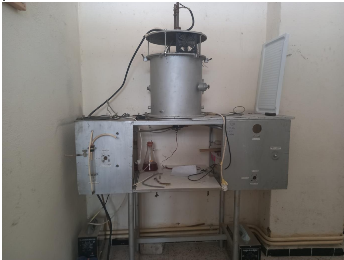
Figure II.1 : four de frittage dans l'état initial
