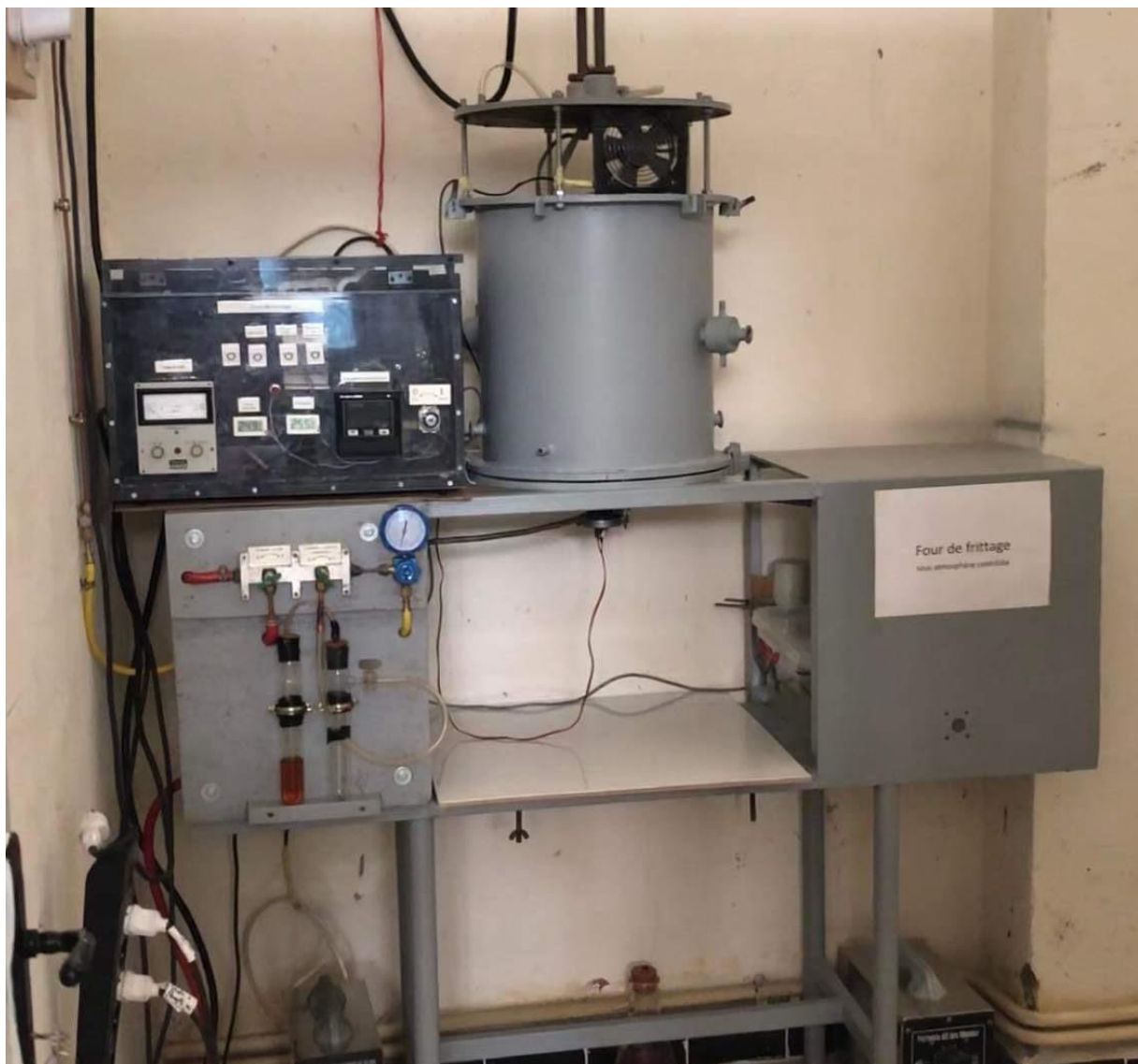
Figure II.2.3.b : four de frittage après rénovation
