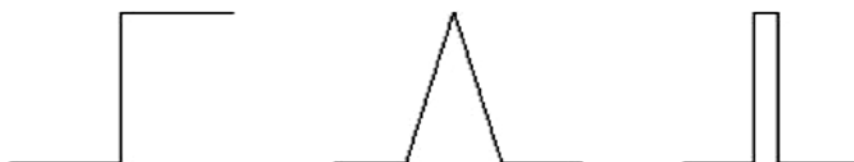
(Figure III.4) : Différents types de contours : marche, toit et pointe [Bensrhair 02,b]
