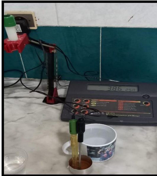
Figure 15 : Mesure du potentiel hydrogène à l'aide d'un ph mètre Hanna pH 211 (image originale 2023).
