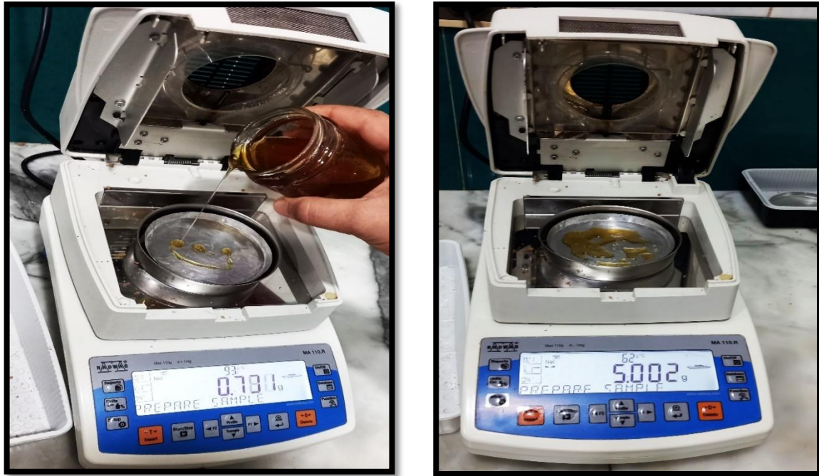
Figure 16 : Méthode de mesure de l'humidité du miel à l'aide d'un dessiccateur (images originales 2023).
