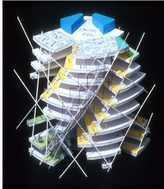
Figure III.13 Maquette montrant le décalage des niveaux, Source: Architecture Steel Stahl Acier 21, swiss Ré
