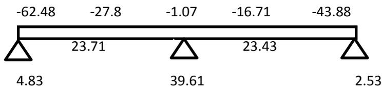
Figure VI-3 : diagrammes des moments fléchissant des poutres secondaires sur appuis et en travée KN.m
