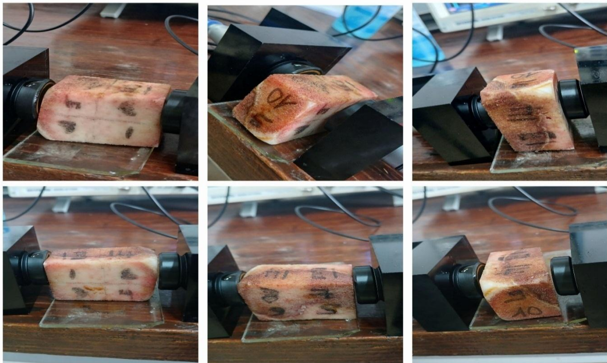
Figure III.16: Déplacement des transducteurs le long de l'échantillon lors des mesures.
