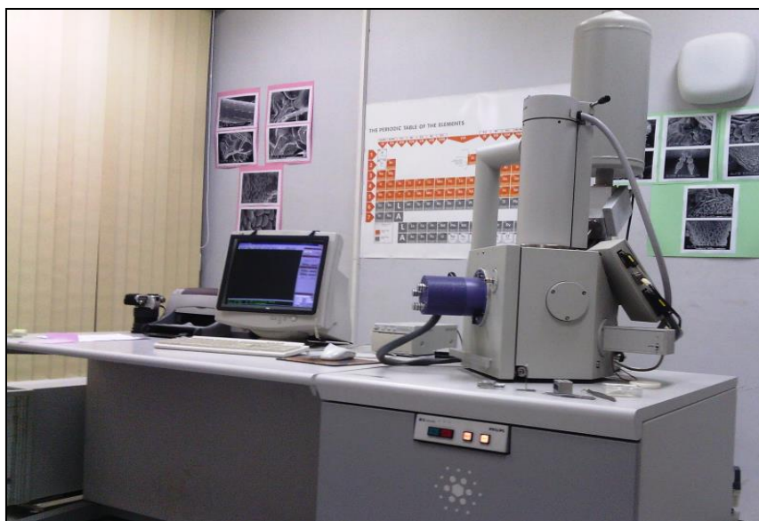
Figure II-6 : Microscopie Electronique à Balayage de type Philips ESEM XL.
