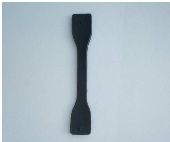
**Figure V.2.** Eprouvette sous forme d'haltère utilisée pour les essais mécaniques et la perte de masse.
