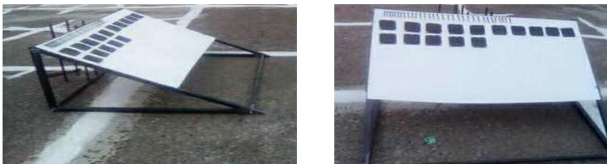
**Figure V.3.** Exposition des échantillons au vieillissement climatique.
