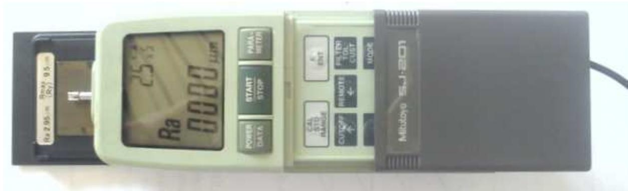
Figure V.13 : rugosimètre à palpeur.
