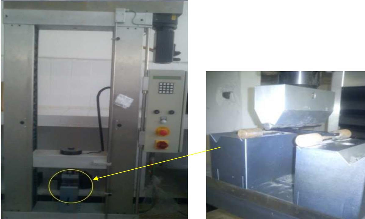
Figure V.15 : machine de flexion Z20.
