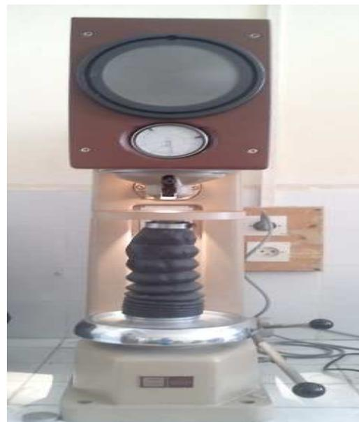
**Figure V.12** : duromètres de type « WOPERT DIA TESTOR RC »
