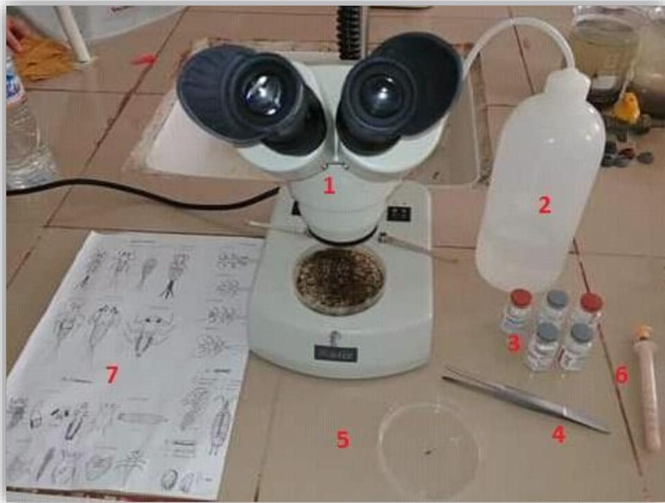
**Figure 09 :** Matériel de pré-tri et de détermination des échantillons au laboratoire
