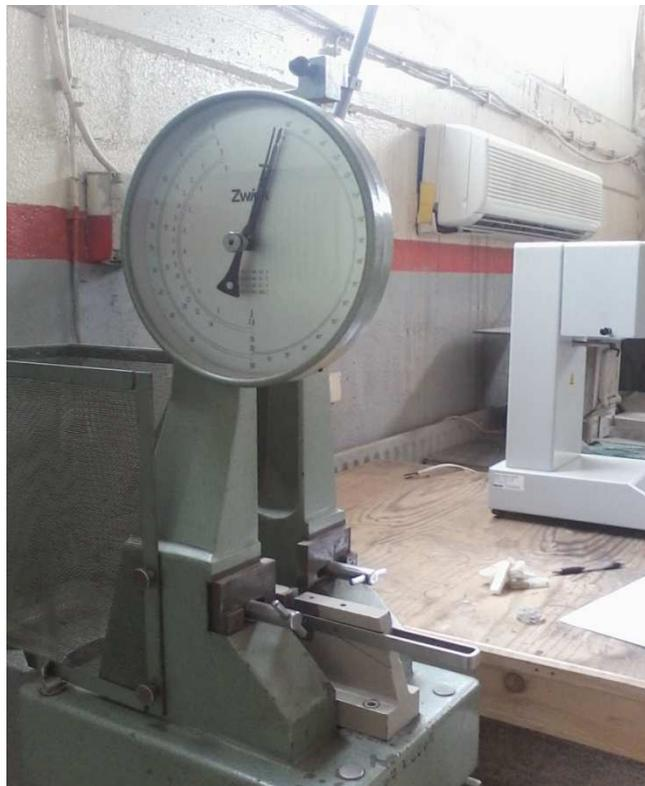
**Figure II.25:** la machine de type Izod (Zwick).
