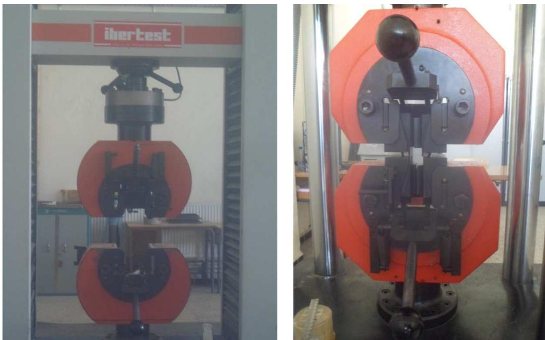
Figure II.3: La machine de traction de type IBERTEST
