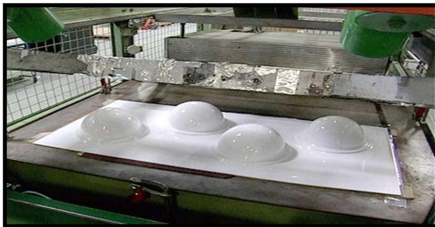
**Figure I.19** : plaque subit un thermoformage.
