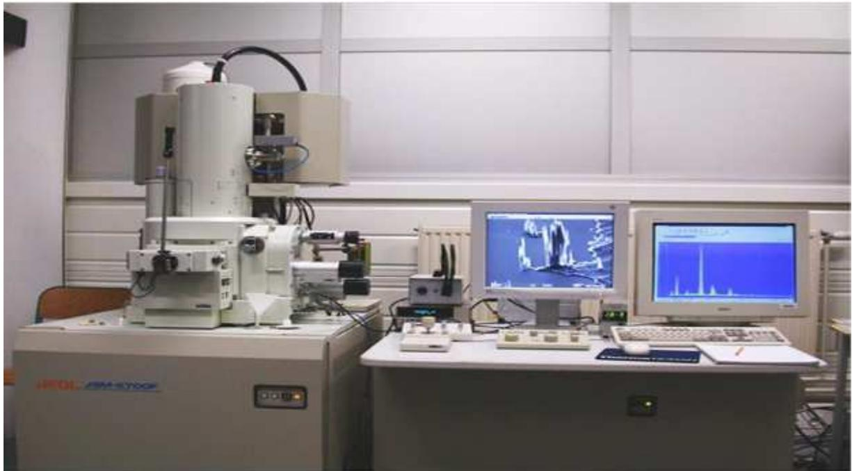
Figure III.2 : Microscope électronique à balayage(MEB).
