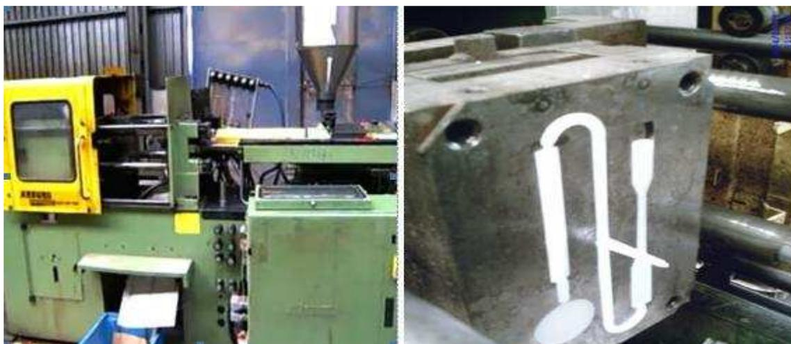
Figure I.4 Machine à injection et moule éprouvette
