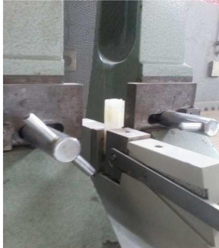
**Figure II.24 :** l'emplacement de l'éprouvette sur la machine de type Izod (Zwick).
