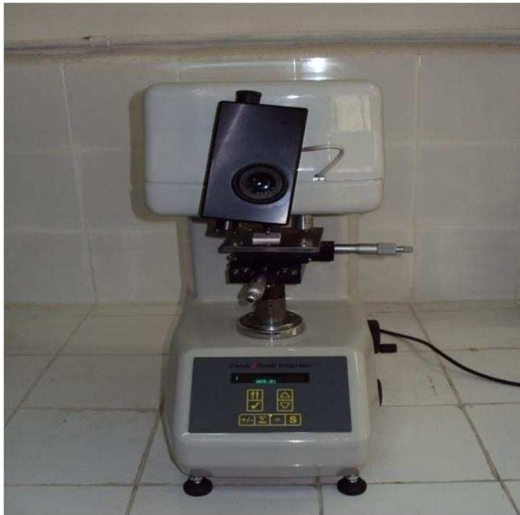
**Figure II.19** : Duromètre type zwick /ROELL.
