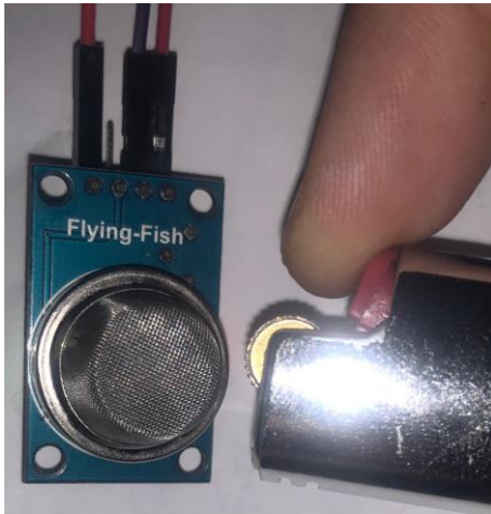
Figure 63: photo de simulation de fuite de gaz
