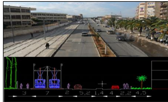
Figure 25 : Photo et coupe schématique de la RN05.
