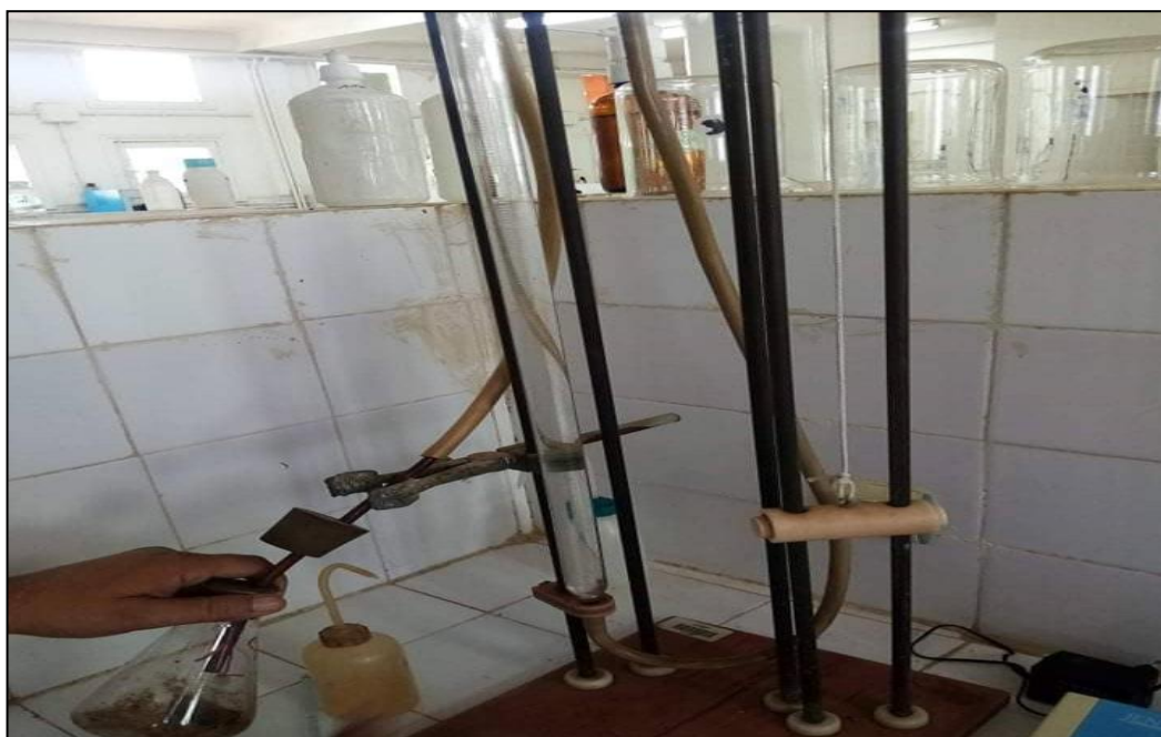
Figure 28 : Dosage du calcaire total à l'aide d'un calcimètre au laboratoire de pédologie à L'INRF (photo originale, 2022)
