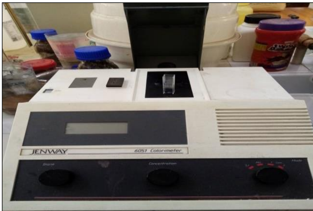
Figure 29 : la détermination du phosphore assimilable à l'aide d'un spectrophotométrie au laboratoire INA (photo originale, 2022)
