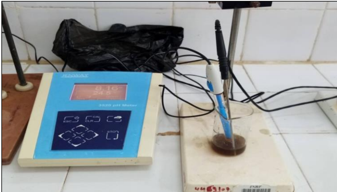
Figure 21 : Détermination du pH à l'aide d'un pH-mètre au niveau du laboratoire de pédologie de l'INRF (photo originale, 2022)
