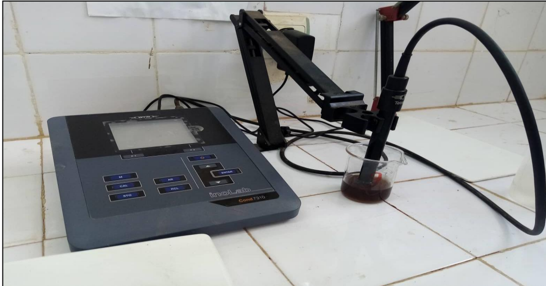
Figure 22 : Mesure de la conductivité électrique au niveau du laboratoire de l'INRF (photo originale, 2022)
