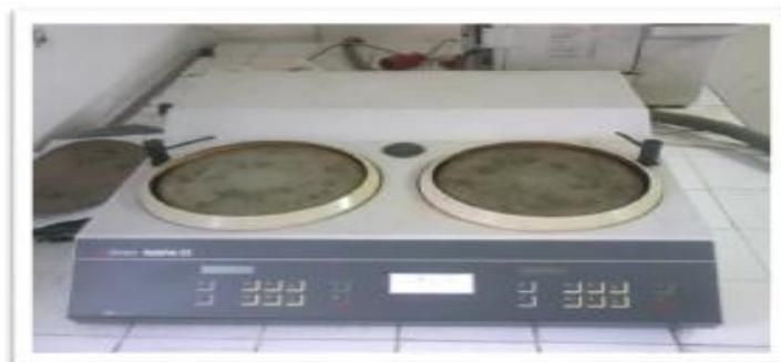
**Figure.III.2.** Polisseuse mécanique
