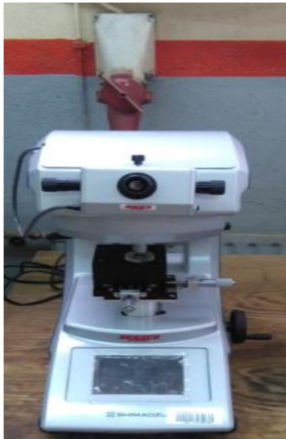
**Figure.III.11.** Microduromètre utilisé
