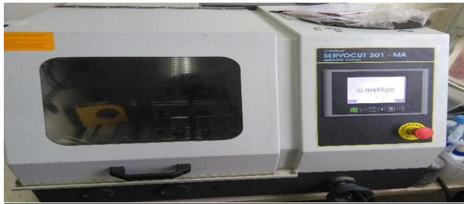
**Figure.III.1.** Tronçonneuse automatique
