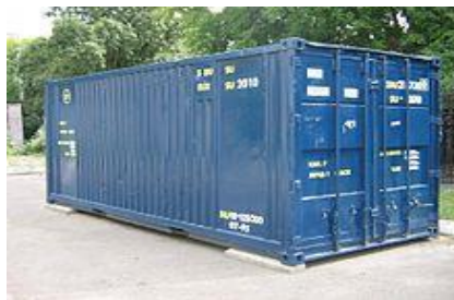
Un conteneur standard de 20 pieds, équivalent à 1 EVP.
