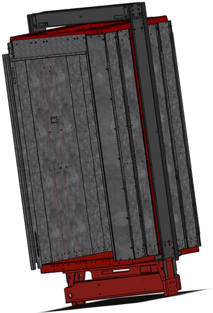
Figure II.8: Cabine d'ascenseur assemblée par le logiciel SolidWorks.
