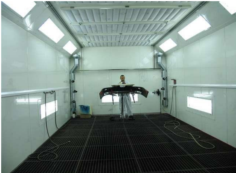
Figure III.20: Méthode de la peinture liquide cuite au four.
