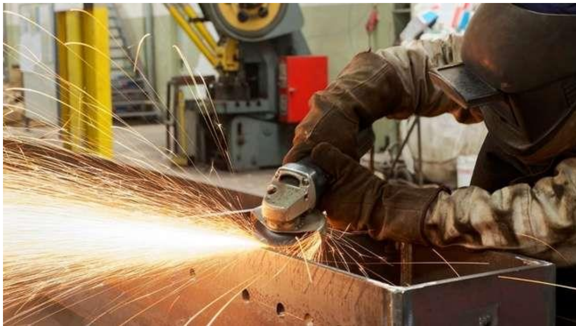
Figure III.8: Meuleuse portative en action sur une pièce métallique.
