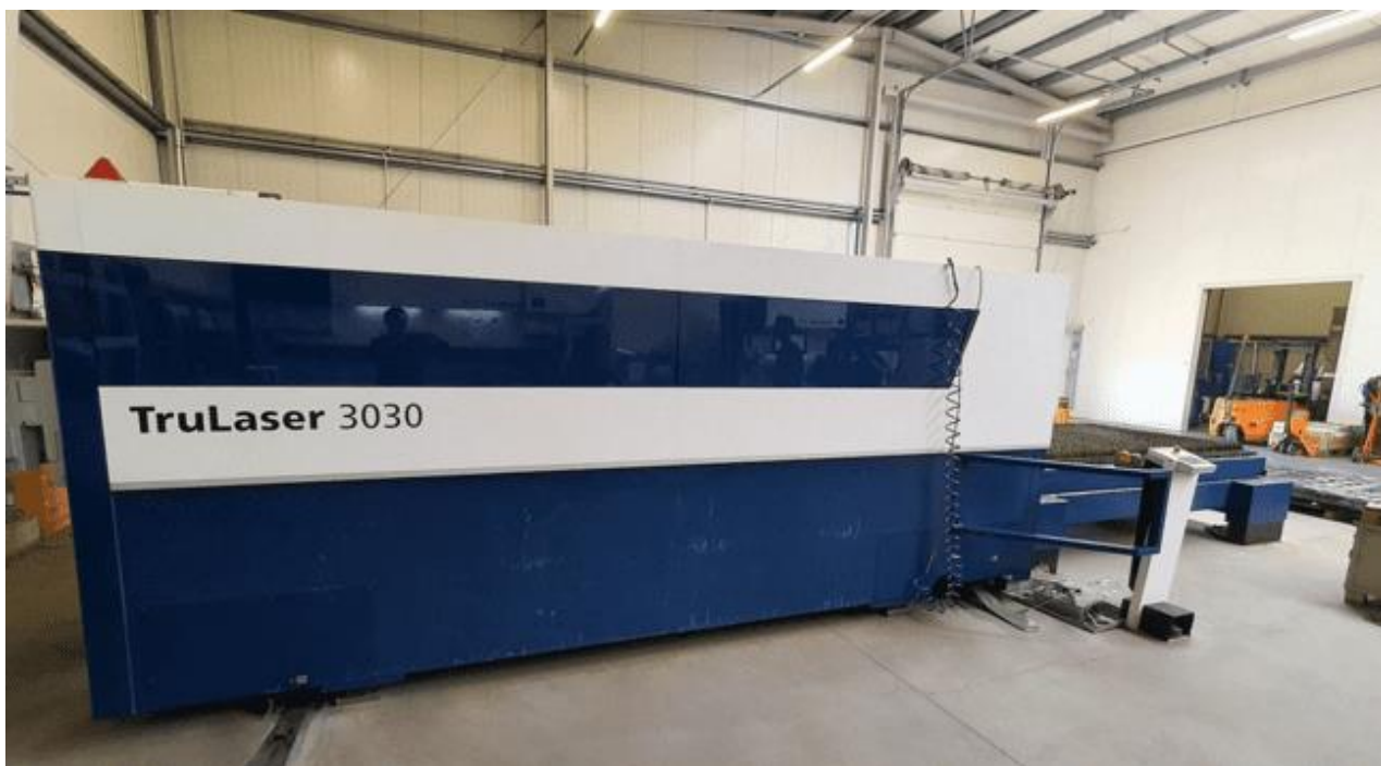
Figure III.4 : Machine de découpe laser fibre Trumpf TruLaser 3030 en atelier.
