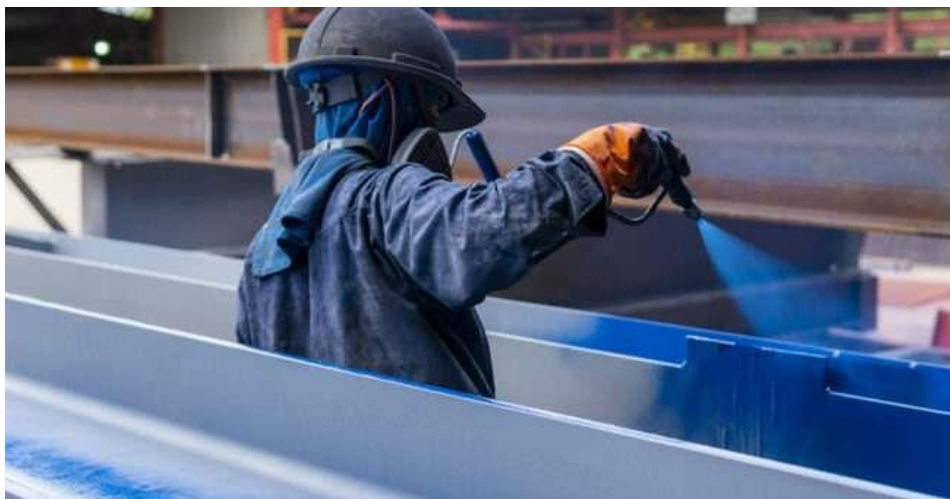
Figure III.18: Méthode de peinture liquide au pistolet.
