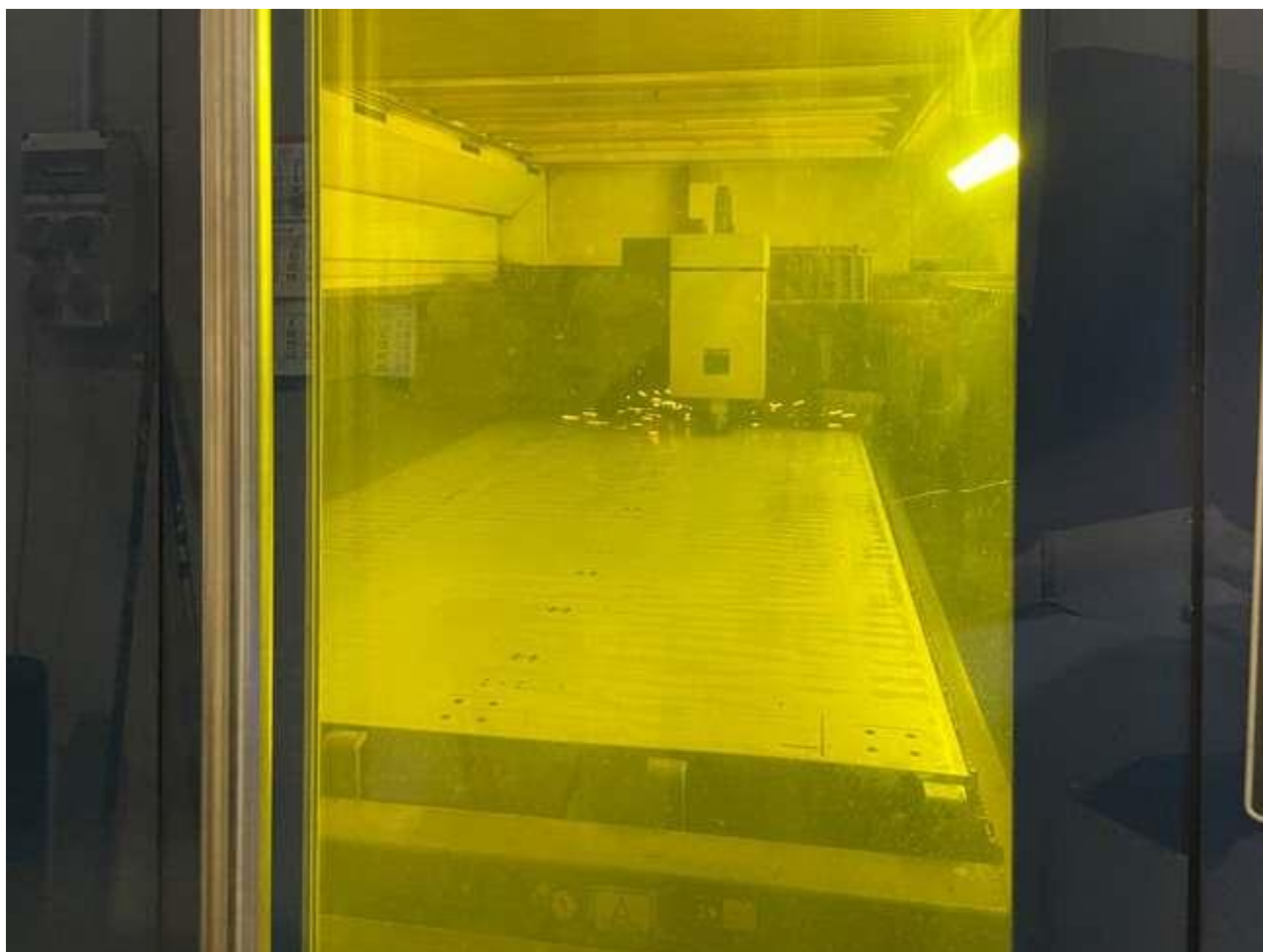
Figure III.5: Machine TruLaser 3030 en fonctionnement lors de la découpe d'une tôle.
