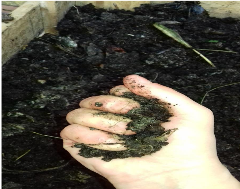
Figure 15: Le test de la poignée pour la vérification du taux d'humidité.
