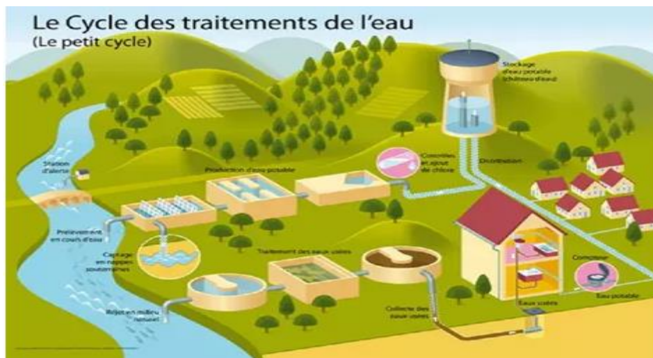
Figure 5: cycle de traitement de l'eau
