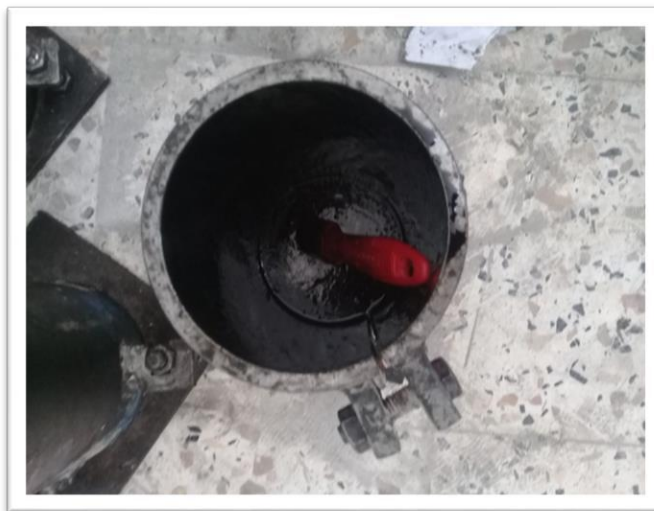
Figure 30: Préparation des moules
