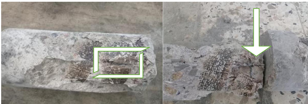
Figure 39: Rupture du PRF de jute.
