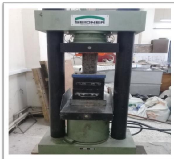
Figure 33: Essai de compression sur un cylindre en béton
