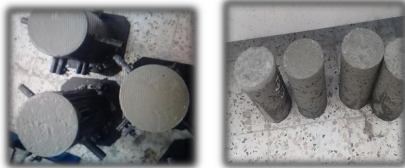
Figure 32: Décoffrage des spécimens en béton
