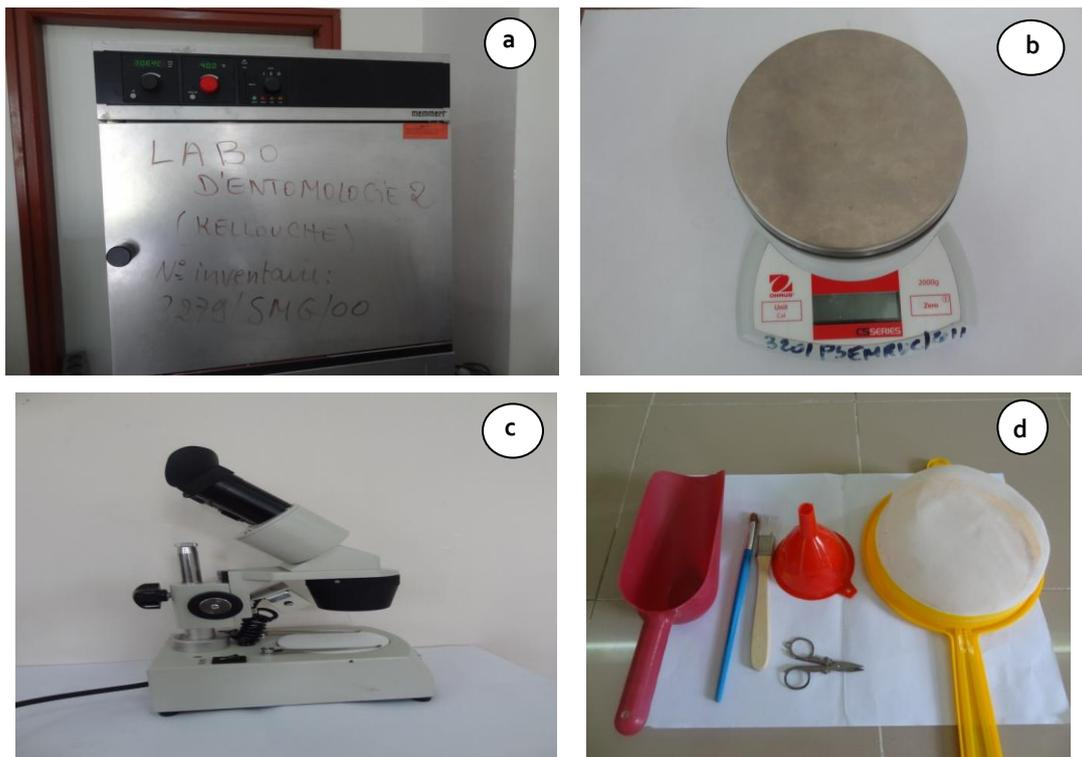
**Figure 9** : Matériels de laboratoire utilisé, (a) : Etuve réfrigérée, (b) : Balance, (c) : Loupe binoculaire et (d) : différents accessoires (Originale, 2015).
