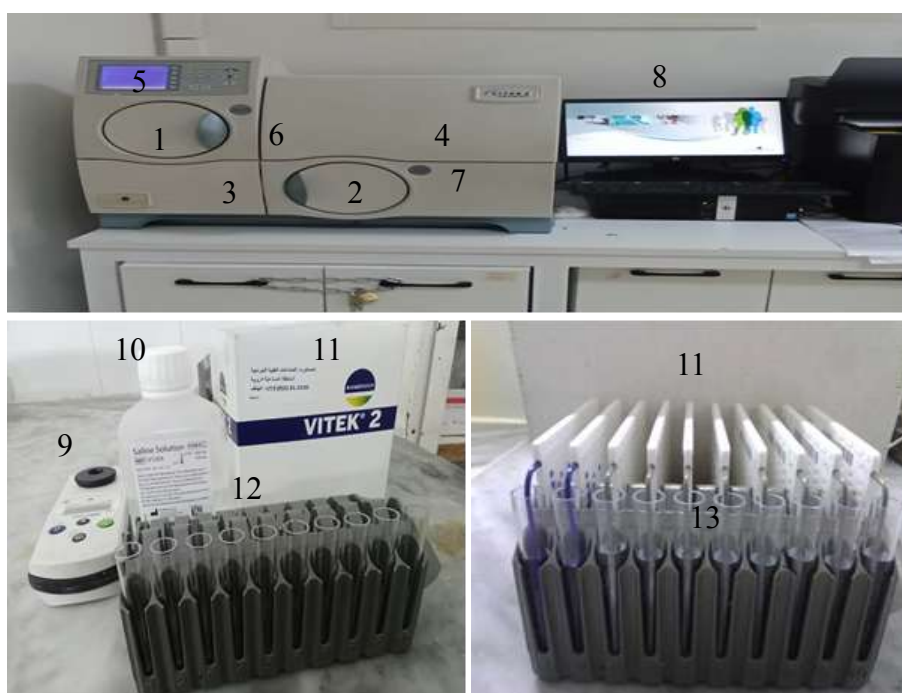
Figure 22 : Image du 58903-VITEK 2 COMPACT et ses accessoires(Photos originales, 2024).
