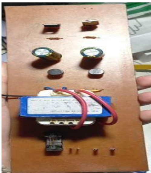
Figure III.28 Carte d'alimentation après le soudage des composants
