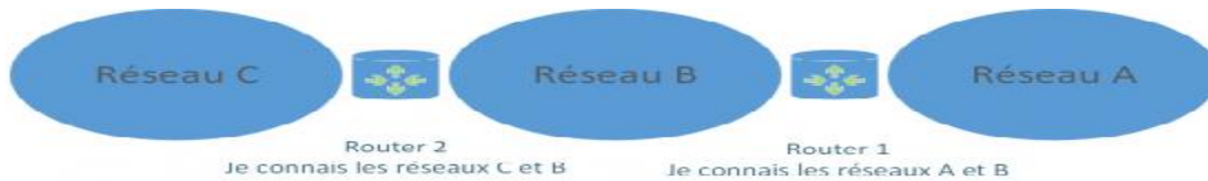
Figure 51 : routage à travers 3 réseaux
