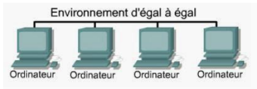
Figure 10 : architecture poste à poste
