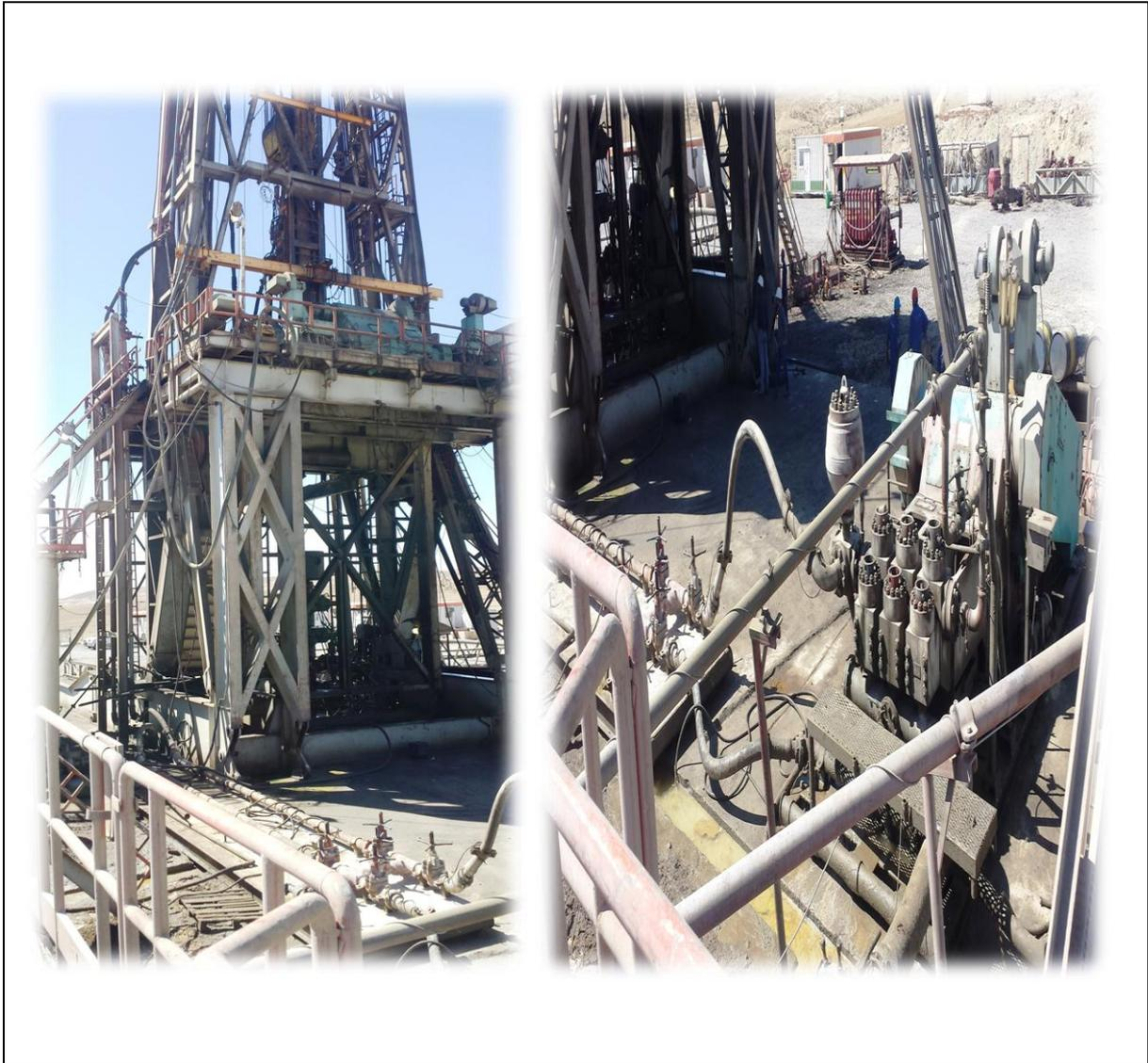
**Figure n°4 :** Pompe à boue alimente la sonde de forage tp206.
