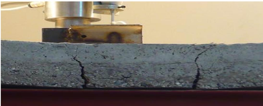
**Figure 27 :** photos montrant la fissuration de l'éprouvette sous l'effet de la force des 3 point
