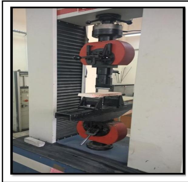
**Figure 26:** presse hydraulique, IBERTEST piloté par un micro-ordinateur
