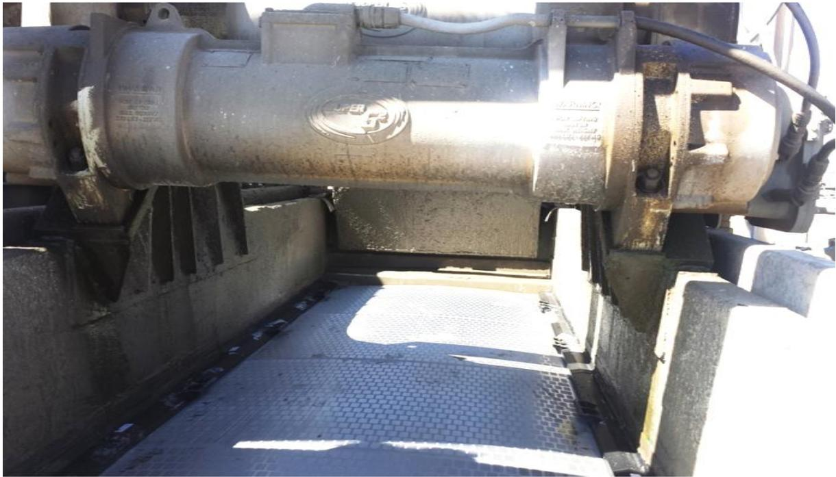
**Figure n°10:** Tamis vibrant (TP206,SIDI AISSA)
