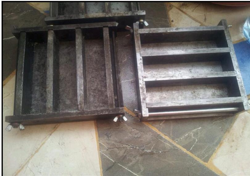
Les moules graissés pour les éprouvettes de mortier
