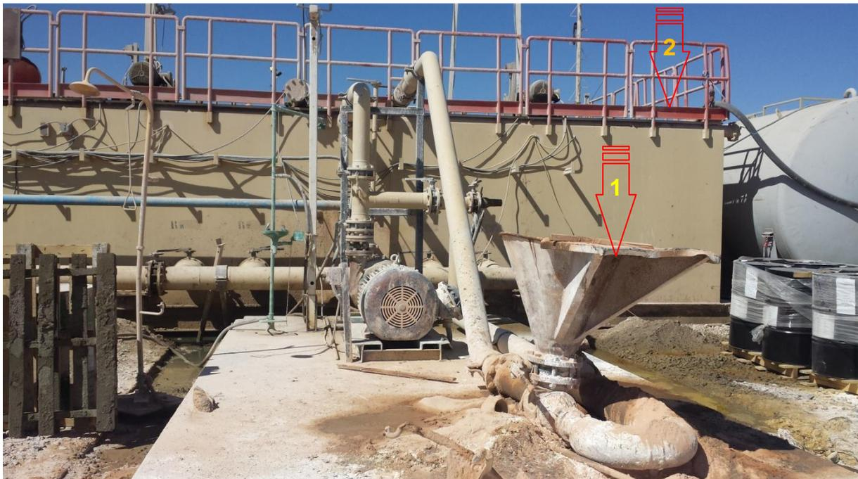
Figure n°3: (1) entonnoir de préparation de boue, (2) bac à boue
