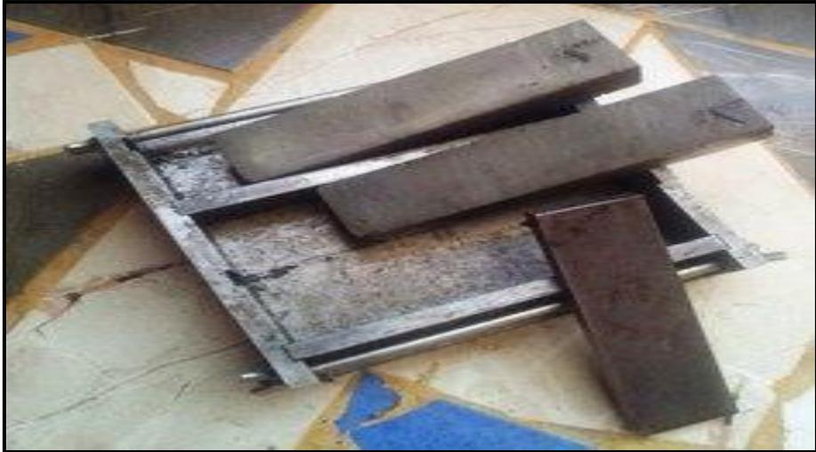
Démoulage des éprouvettes
