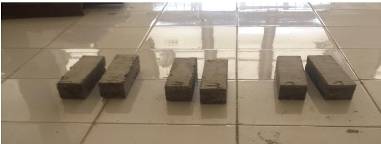
**Figure 25:** éprouvette pour l'essai de flexion et compression
