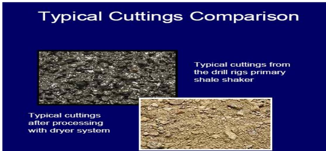
**Figure n°13:** comparaison typique de déblais entre le tamis et la centrifugeuse VertiG
