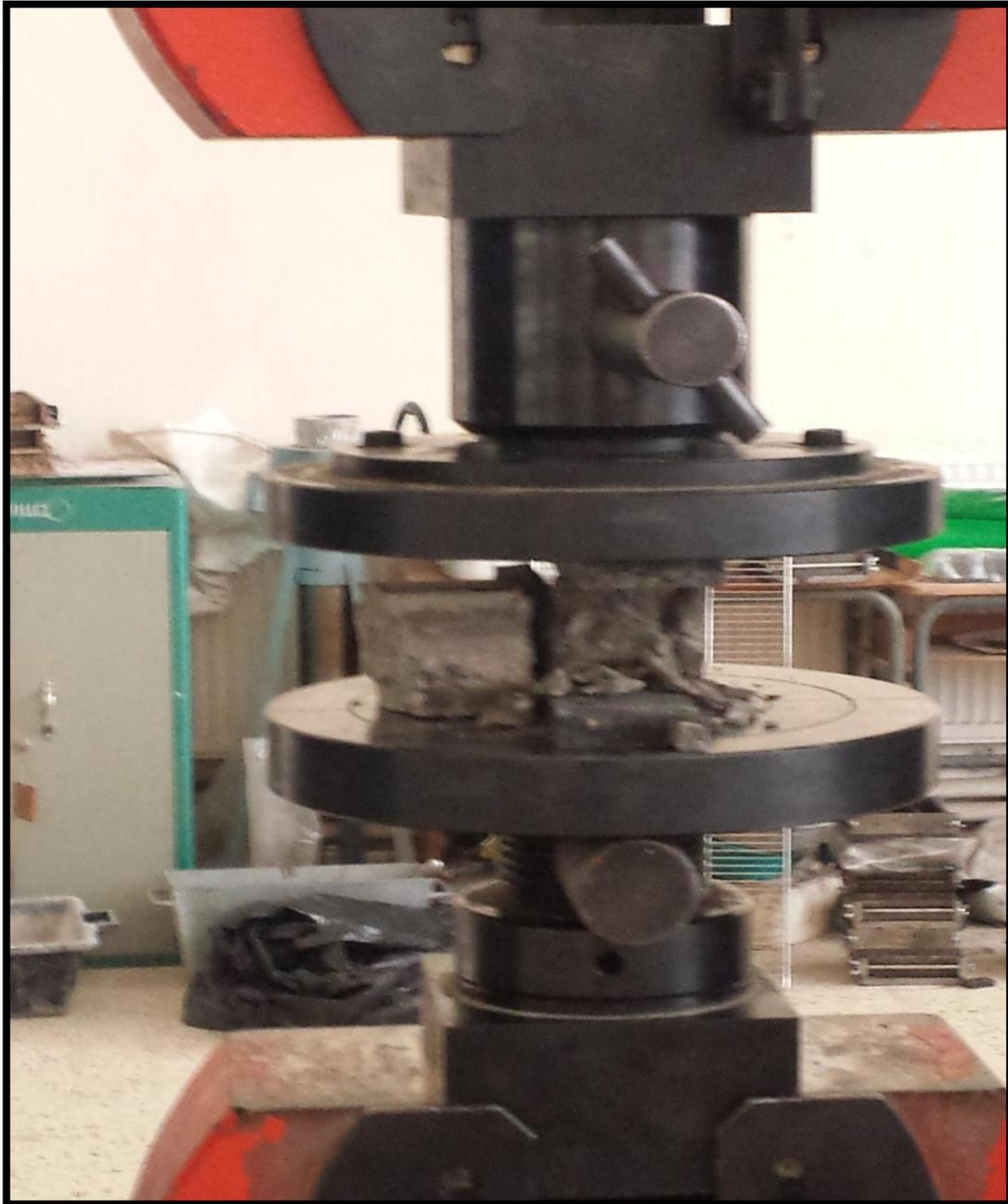
**Figure 31:** Echantillon entre deux plaques métalliques prêt à la compression.
