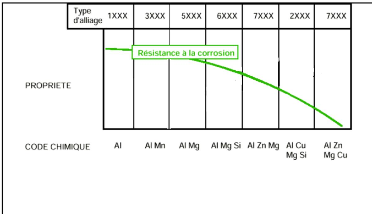
**Figure. I.1 :** effet des éléments d'addition sur la résistance à la corrosion des alliages d'aluminium [28].
