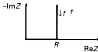
**Figure. III.5 :** Représentation de l'impédance  $Z$  du circuit en série dans le plan de NYQUIST
