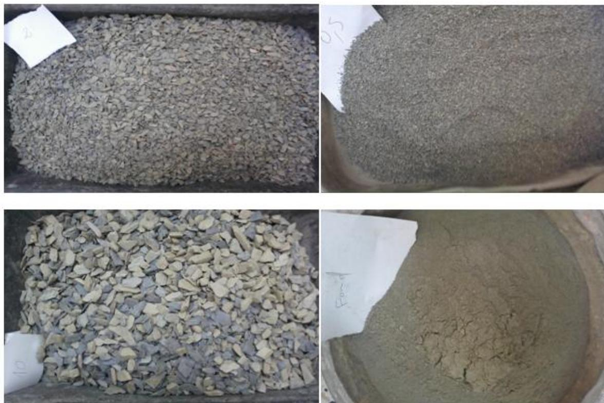
Figure III.3 : Granulats de schiste après concassage.
