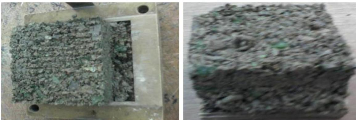
Figure V.6 : Echantillons (schiste + verre) après cisaillement.
