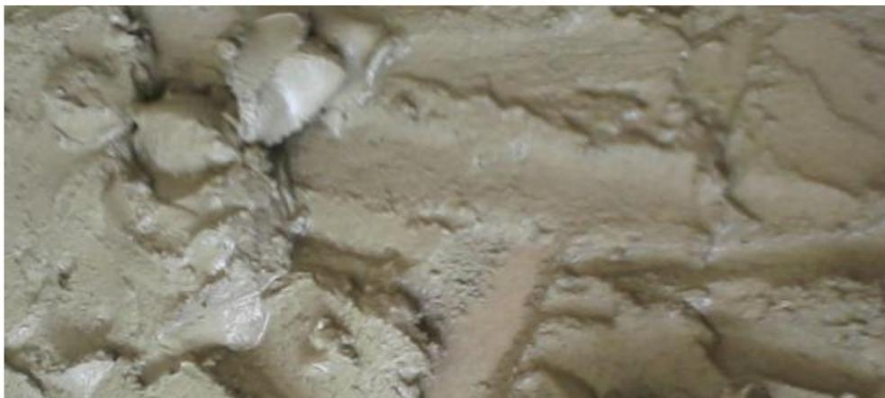
Figure III.7: Détermination des limites de plasticité  $w_p$ .
