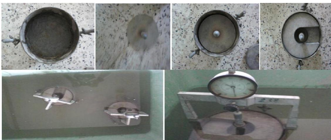
Figure IV.18 : Détermination de l'indice CBRimm.
