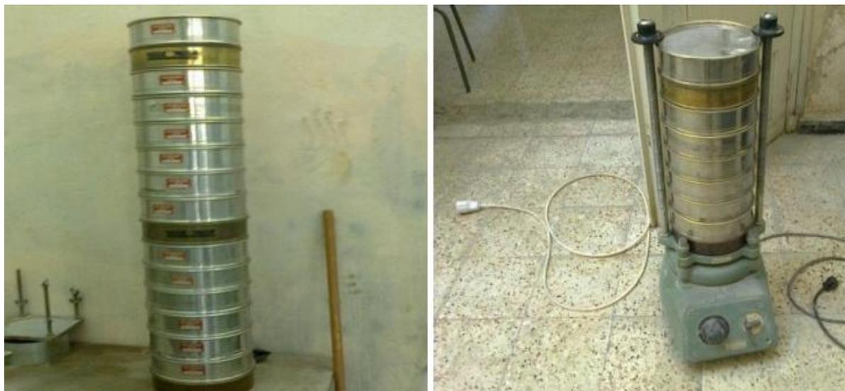
Figure III.8: Analyse granulométrique par tamisage.
