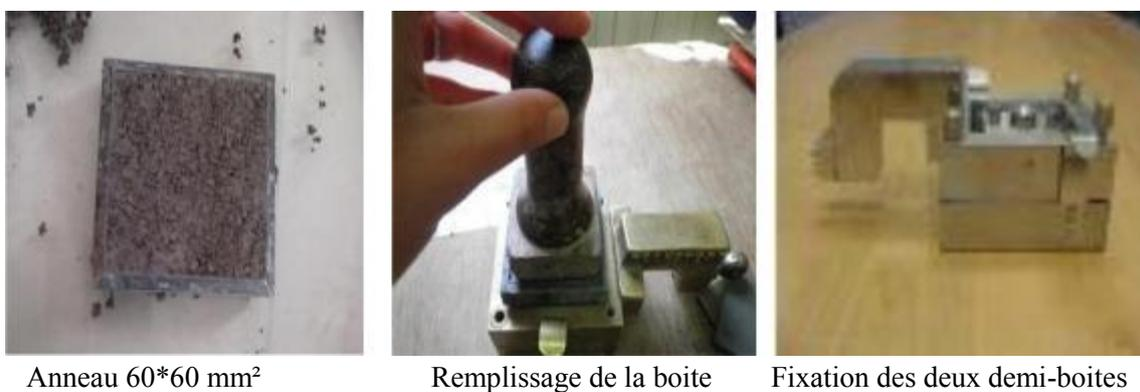
Figure V.5 : Mode opératoire du cisaillement.
