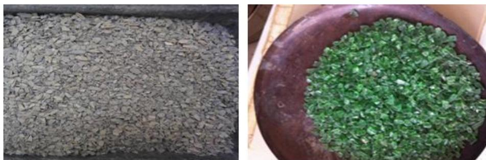
Figure III.1 : Les granulats de schiste et les débris de verre d'emballages.
