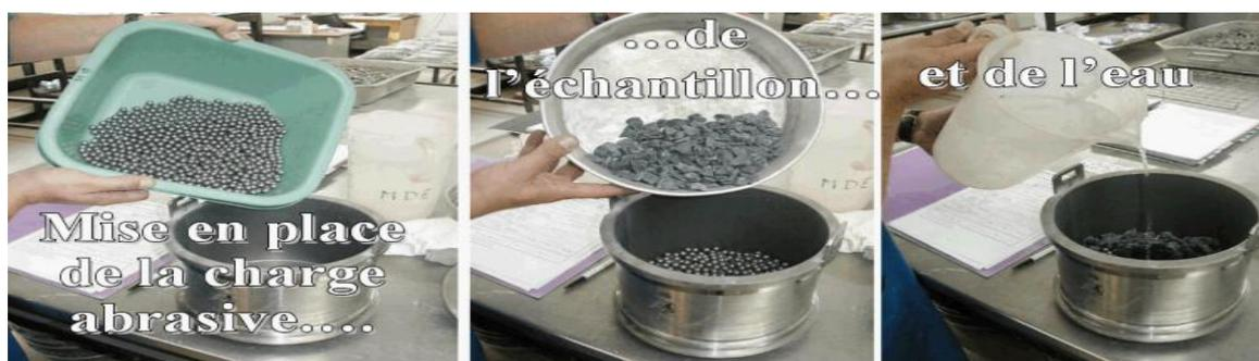
Figure IV.25 : Mode opératoire d'essai micro deval.
