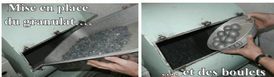
Figure IV.26 : Mise en place du granulat essai Los Angeles.
