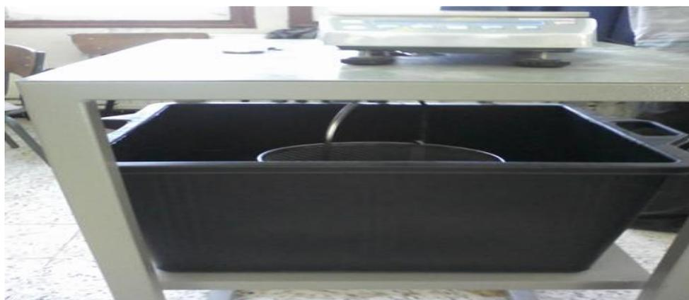
Figure III.4 : Appareillage utilisée pour peser hydrostatique.
