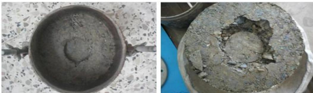
Figure IV.19 : Eprouvettes après poinçonnement.
