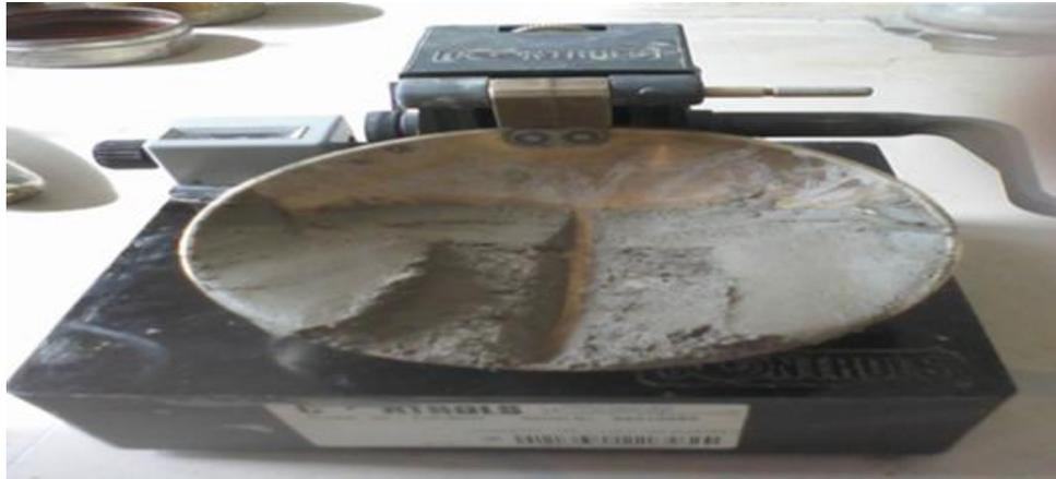
Figure III.6: Détermination des limites de liquidité  $w_l$ .
