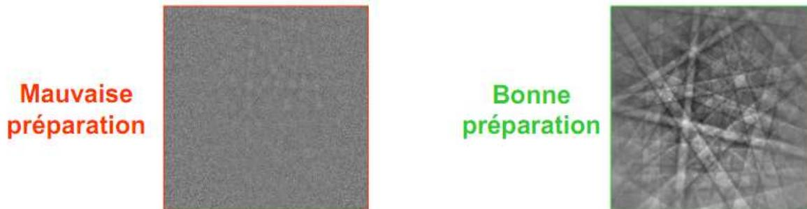
*Figure. II.5. Clichés de diffraction EBSD (Kikuchi) montrant le résultat d'une bonne et mauvaise préparation de l'échantillon*
