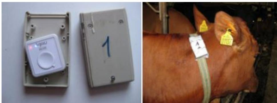
Fig 1.8: Boitier de positionnement GPS attaché à une vache.
