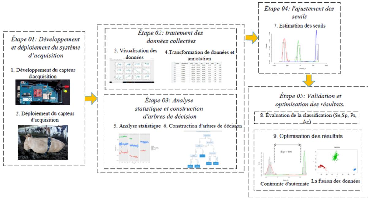
Fig 4.1: Enchaînement de la procédure de développement du système de classification comportementale.
