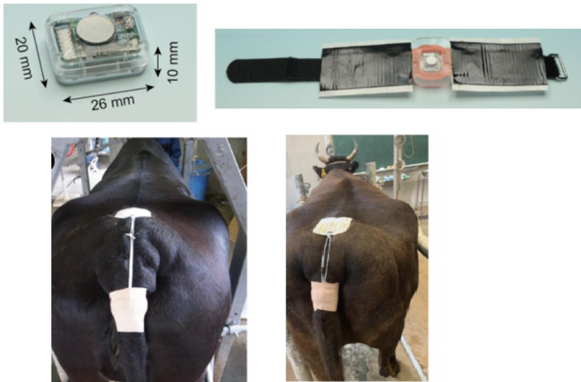
Fig 1.14: Capteur de température attaché à la queue permettant le monitoring de la fièvre.
