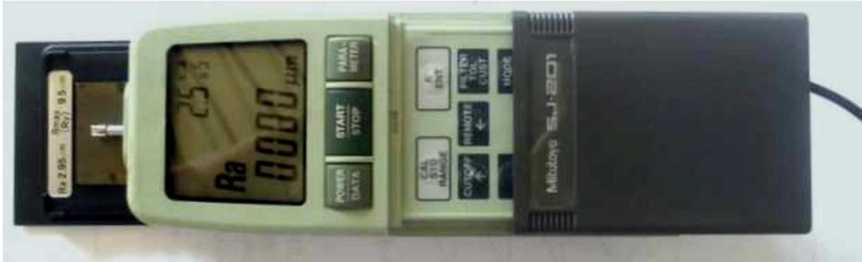
Figure V.17 : rugosimètre à palpeur
