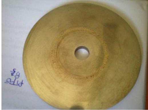
Figure V.28 : Marques d'usure lors de l'essai de perte de masse bronze/acier.
