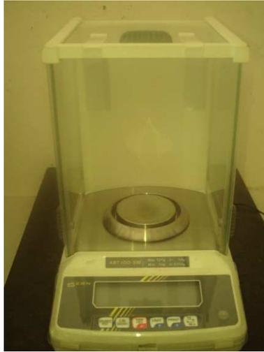
Figure V.25 : balance électrique
