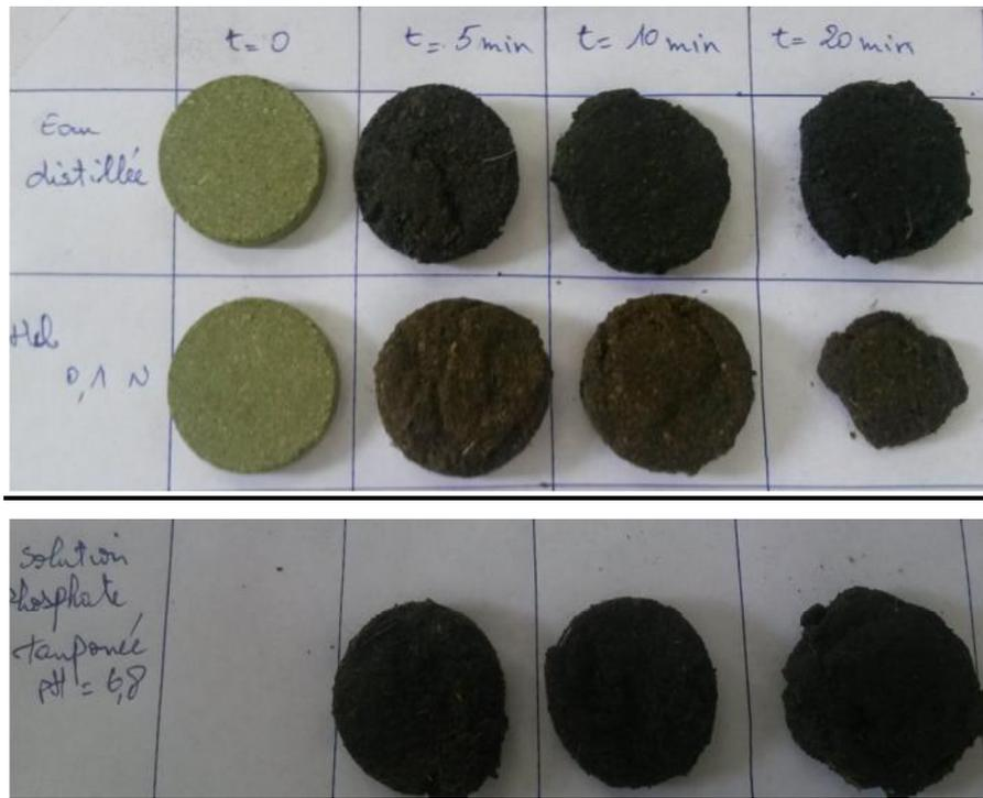
**Figure 5** : Aspect morphologique des comprimés en fonction du temps d'immersion dans les
