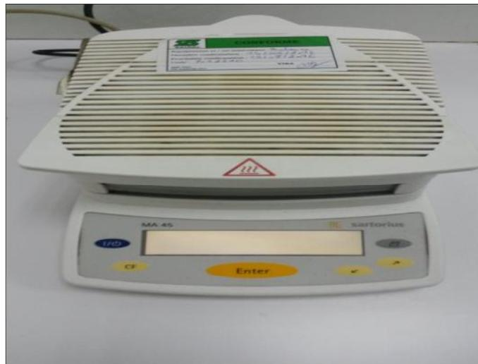
**Figure 20** : Appareil Dessiccateur (Sartorius MA 45)
