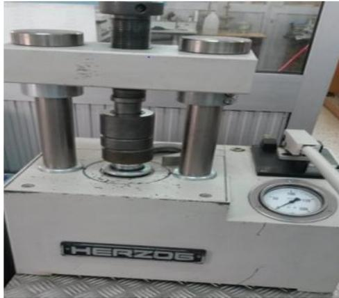
Figure 18 : Appareil de la pastilleuse (HERAZOG)
