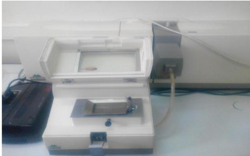
**Figure 17 :** Appareil de granulométrie de diffraction par laser
