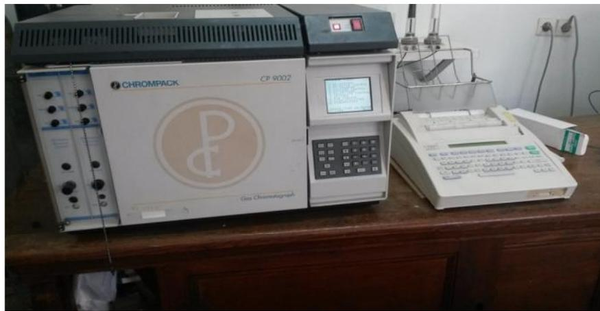
**Figure 16** : Appareil de la Chromatographie phase gazeuse (CHROMPACK CP 9002)
