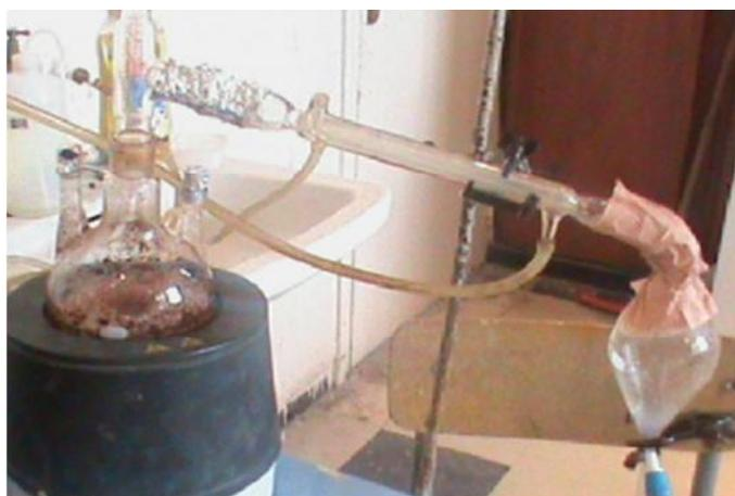
**Figure 15** : Montage de l'extraction de la matière grasse par soxlet
