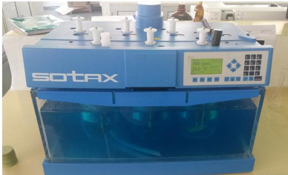
**Figure 21** : Appareillage de dissolution (SOTAX)
