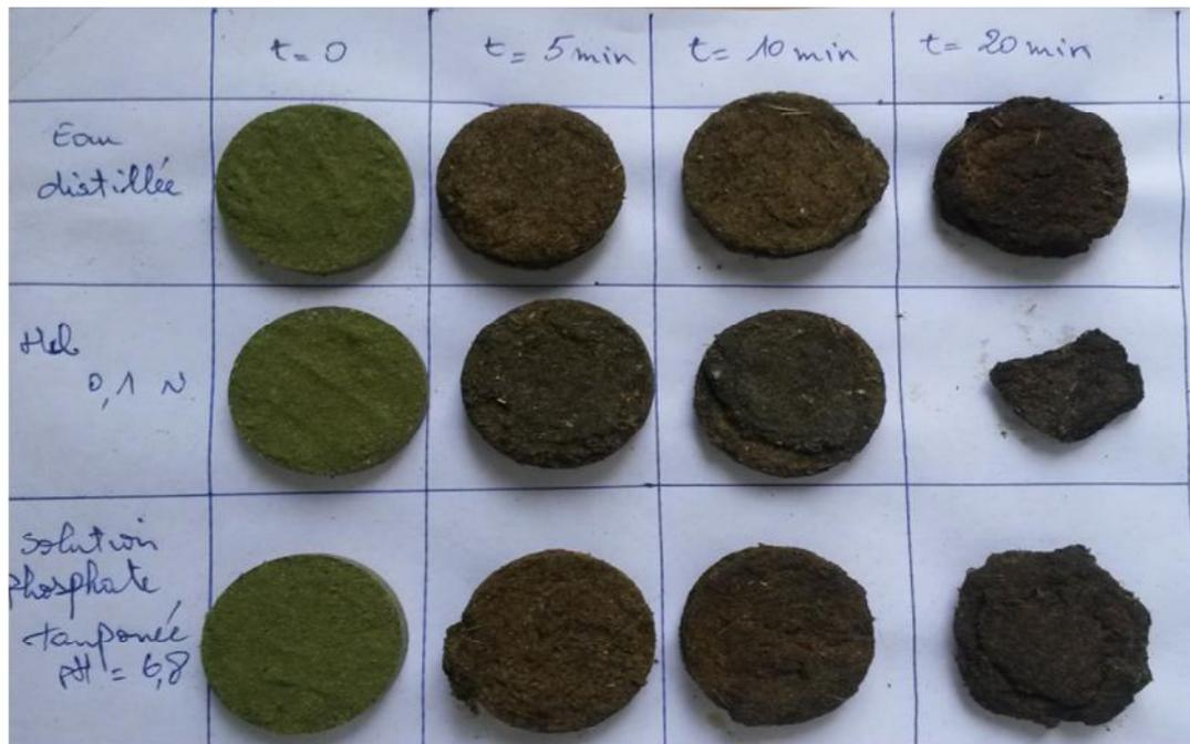
**Figure 7 :** Aspect morphologique des comprimés (phénomène d'érosion des comprimés) observés dans l'eau distillée, la solution tampon phosphatée pH 6,8 et l'HCl 0,1N)
