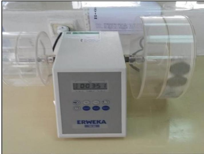
**Figure 19** : Photo d'un Friabilimètre de type (ERWEKA TA 40).
