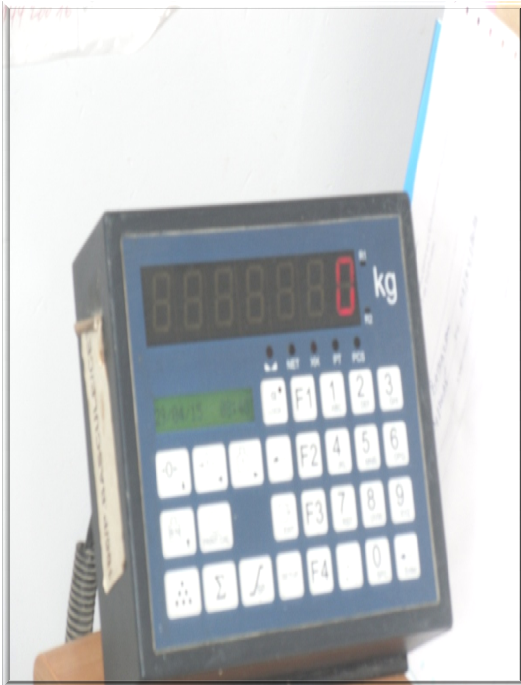
Figure 08: Afficheur des poids, composante du pont bascule.
